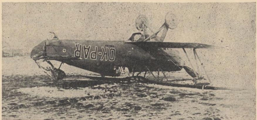
Stroj, který byl předlohou pro povrchovou úpravu prototypu makety (výr. čís. 195 ze 4. série), měl smůlu. Dne 7. 2. 1938 s ním tehdejší kpt. Ryppl (dnes gen. v. v.) přistál v míze u Dvora Králové n. L. a dopadlo to takto. Snímek ale zařazujeme z jiného důvodu: ukazuje, že tato letadla létala i bez krytí kol, ať mnozí dnes jednoznačně tvrdí opak. – Poznáváme, že kromě tohoto snímku skutečného letadla je na všech ostatních snímcích MODEL.
