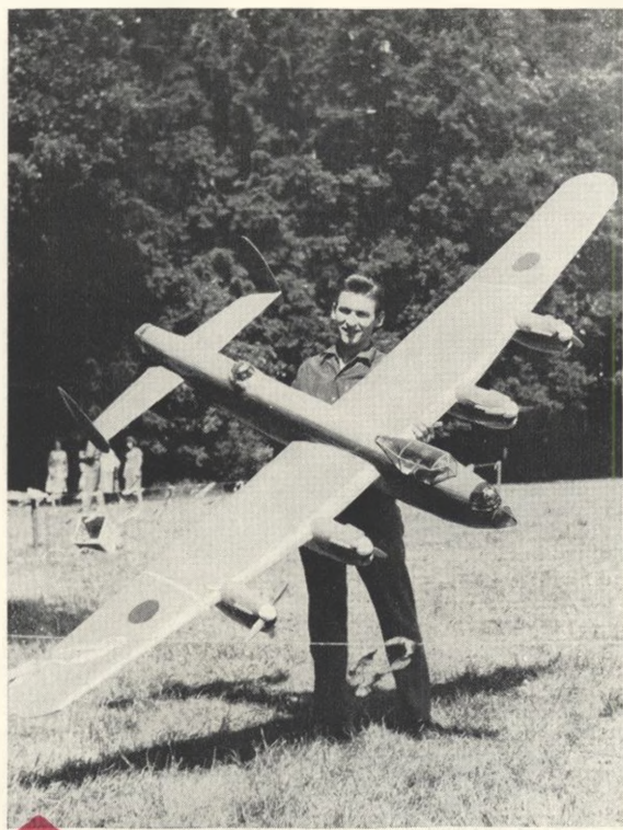
Obří U-maketu Avro „Lancaster“ postavil J. Lexa ze Srubce u Č. Budějovic. V měřítku 1 : 10 má rozpětí 3110 mm, nosnou plochu 119,5 dm 2 , s motory Vltavan 5 váží 5700 g
