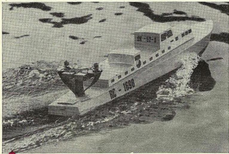
Zajímavý model Zd. Krejsy z LMK Žamberk je zjednodušený hlídkový člun BR-503 podle plánu Modelář, postavený ve dvojnásobné velikosti. Pohon je dvěma motory MVVS 2,5 R s leteckými vrtulemi, řízení soupravou Gama a amatérským servem (polohy: levá-neutrál-pravá)
