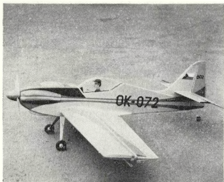
Z 50L – upoutaná polomaketa čs. akrobatického letadla (pro nová pravidla kategorie SUM); rozpětí 990 mm, motor 2,5 cm 3 , smíšený materiál. (Viz Modelář č. 11/1976.) Číslo 69
