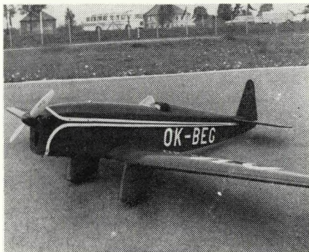
Be 56 Beta Major – RC maketa československého letadla; poměr zmenšení 1:6, rozpětí 1776 mm, motor 10 cm 3 , stavba z balsy. (Viz Modelář č. 2/1977.) Číslo 81 (s)
