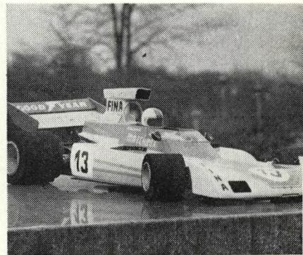
SURTEES TS 16 – polomaketa automobilu formule (kategorie RC-V1); délka 525 mm, motor 2,5 cm 3 , tuzemský materiál. (Viz Modelář č. 6/1977.) Číslo 84 (s)
