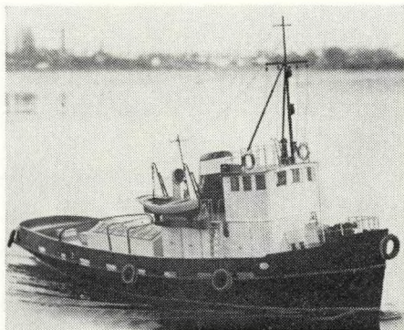
PAOLO-M – maketa italského přístavního remorkéru; poměr zmenšení 1:25, délka při tomto poměru 1140 mm, pohon elektrickým nebo spalovacím motorem, tuzemský materiál. (Viz Modelář č. 1/1977.) Číslo 80 (s)
