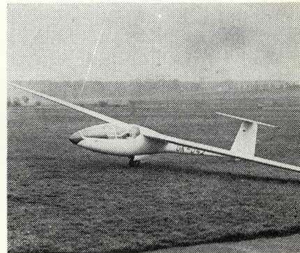
VSO 10 – RC maketa nového československého větroňu; rozpětí 3000 mm, řízení kolem tří os, stavba z balsy. (Viz Modelář č. 3/1977 – skut. letadlo a č. 7/1977 – model.) Číslo 85 (s)
