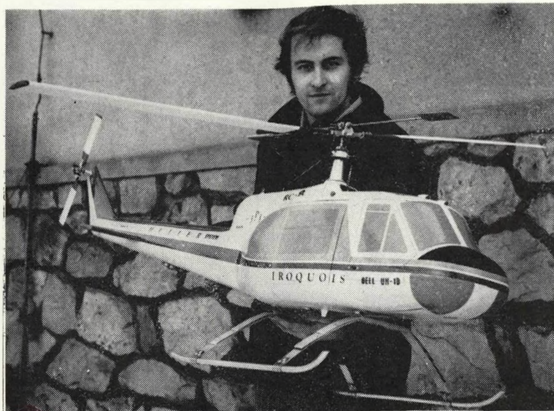
Maketa vrtulníku Bell UH-1B o délce 1800 mm a průměru rotoru 1500 mm je amatérským dílem bratrů J. a P. Janouškových z Valašského Meziříčí. Hmotnost modelu s motorem MVVS 10 cm 3 a amatérskou RC soupravou je 5,5 kg. Zvláštnosti jsou funkční světelné majáky, signalizující pokles hladiny paliva v nádrži
