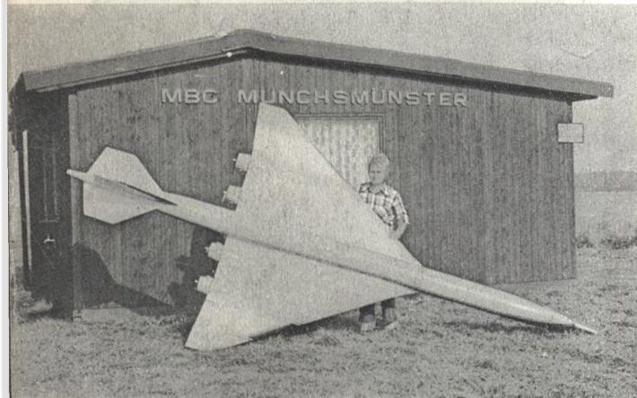
▲ Nadzvukové letadlo dopravní Boeing B-2707 zůstalo zatím pouze v projektu. S jeho maketou RC o rozpětí 2350 mm, délce 5300 mm a hmotnosti 19,5 kg, poháněnou čtyřmi motory Webra Speed-61 (10 cm<sup>3</sup>) však již létat H. Galler z NSR
