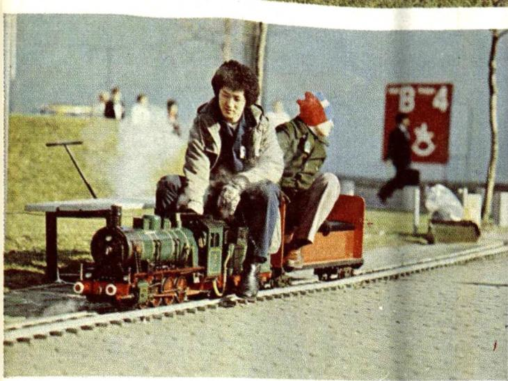
▲ Vývoj železničního modelářství prý směruje k tzv. zahradní železnici – aspoň podle tvrzení výrobců velkých modelů. Firma Zimmermann předváděla na letošním veletrhu v Norimberku lokomotivu ř. BR 55 2781 o rozchodu 5" (127 mm)
