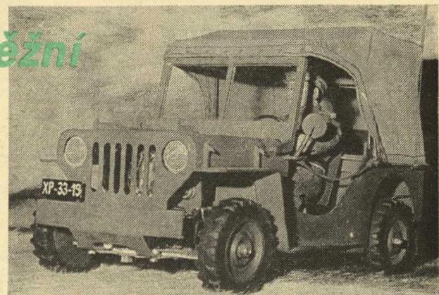
staví Petr Richter z Varnsdorfu. Motokára v měřítku 1:5 je řízena soupravou Modela Digi, umístěnou v sedačce; pouzdro se zdroji znázorňuje nadříz. Servo řízení je uloženo za polomaketou motoru. Při pohodu elektromotorem Mabuchi dosahuje model z Krastenu (rázuvzdorný polystyren) rychlosti 19 km.h<sup>-1</sup>.
