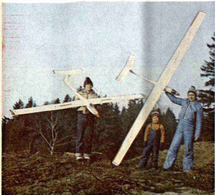
▲ RC polomakety Nimbus II o rozpětí 3800 mm J. Kysely a M. Pokorného z LMK Lomnice nad Popelkou jsou řízeny soupravami Modela Digi
