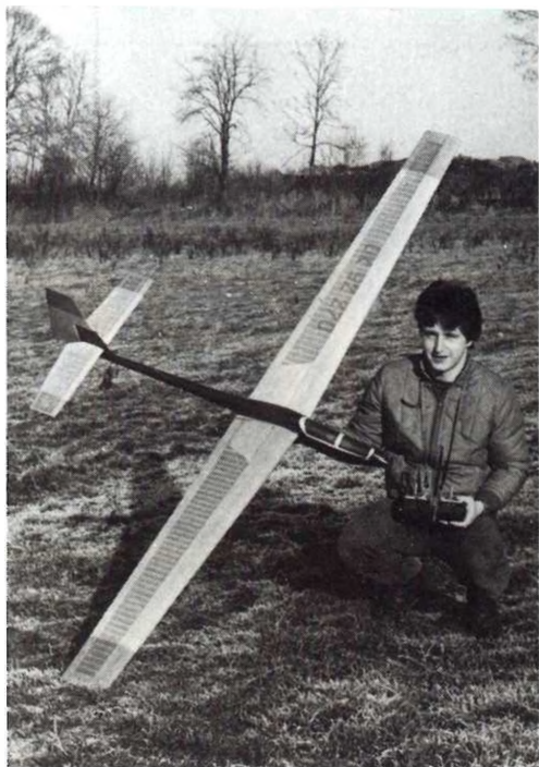
▲ Při stavbě větroňů RC V2 s méně obvyklým vzepětím do V posloužil S. Vackovi z Králík jako vzor model mistra Itálie z roku 1979. Větroň o rozpětí 2600 mm a hmotnosti 1500 g má ovládanou směrovku a výškovku
