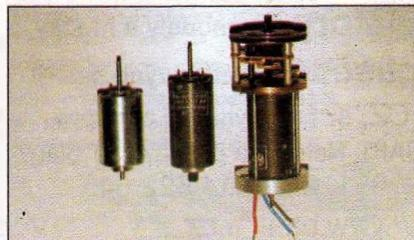
Elektromotory, které jsou vhodné pro modely lodí. Motory jsou osazeny stěracími „uhlíky“ 1) Dvanáctivoltový motor s převodovkou, výstupní otáčky 100 ot/min. Technické parametry: 12 V / 8 W / 8000 ot/min, 1,9 A. 2) Dvanáctivoltový motor, techn. parametry jako v prvním případě. 3) Dvanáctivoltový motor (kratší typ). Technické parametry: 12 V, 8 W, 8000 ot/min, 1,4 A.
