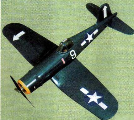
Námofní Corsair F4U (měř. 1:14, profil NACA - 2416, rozpětí 930 mm, délka 730 mm). K pohonu je vhodný elektromotor řady 500 nebo 600, případně spalovací motor s objemem 1,5 až 3,5 cm<sup>3</sup>
