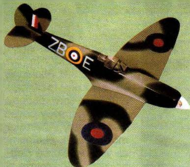
Slavný anglický Spitfire Mk-IX v měřítku 1 : 14 (profil MH-22, rozpětí 800 mm, délka 680 mm, pohon elektromotorem Speed 400 nebo 480).
