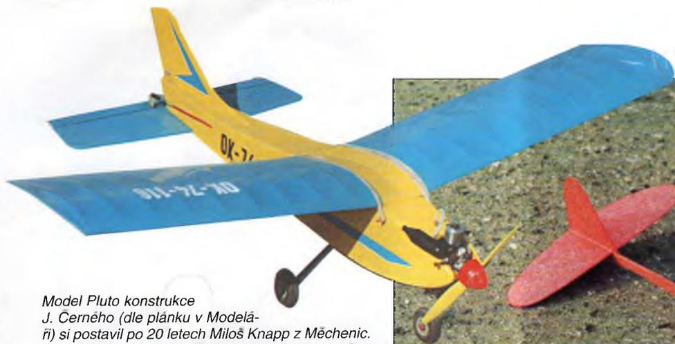
Model Pluto konstrukce J. Cerného (dle plánek v Modelářii) si postavil po 20 letech Miloš Knapp z Měchenic. Jde o třetí model tohoto typu, který je vylepšen o ovládání výškovky. Jeho první dva „Plutáci“ nekončili havárií ale sešlostí věkem. Třetí Pluto je osazeno motorem MVVS 1,5 GFS-Mikro a ovládáno RC soupravou Graupner FM 314.
