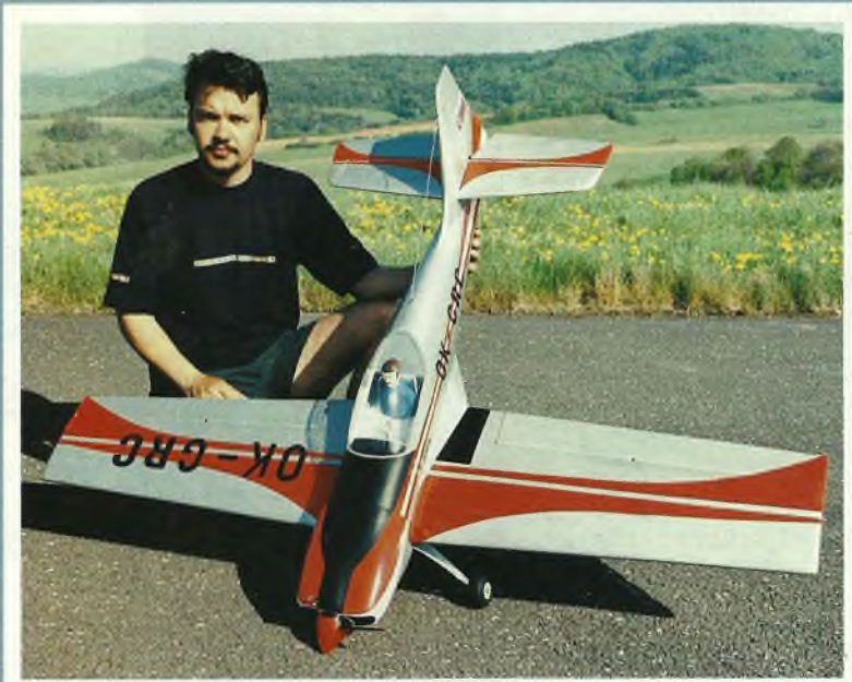
Slávo Rau z LMK Zvolen si postavil polomaketu akrobatického letadla Zlin Z-50L o rozpětí 1600 mm. Model o hmotnosti 4580 je poháněn motorem Webra 120R a ovládán RC soupravou Futaba FC-18
