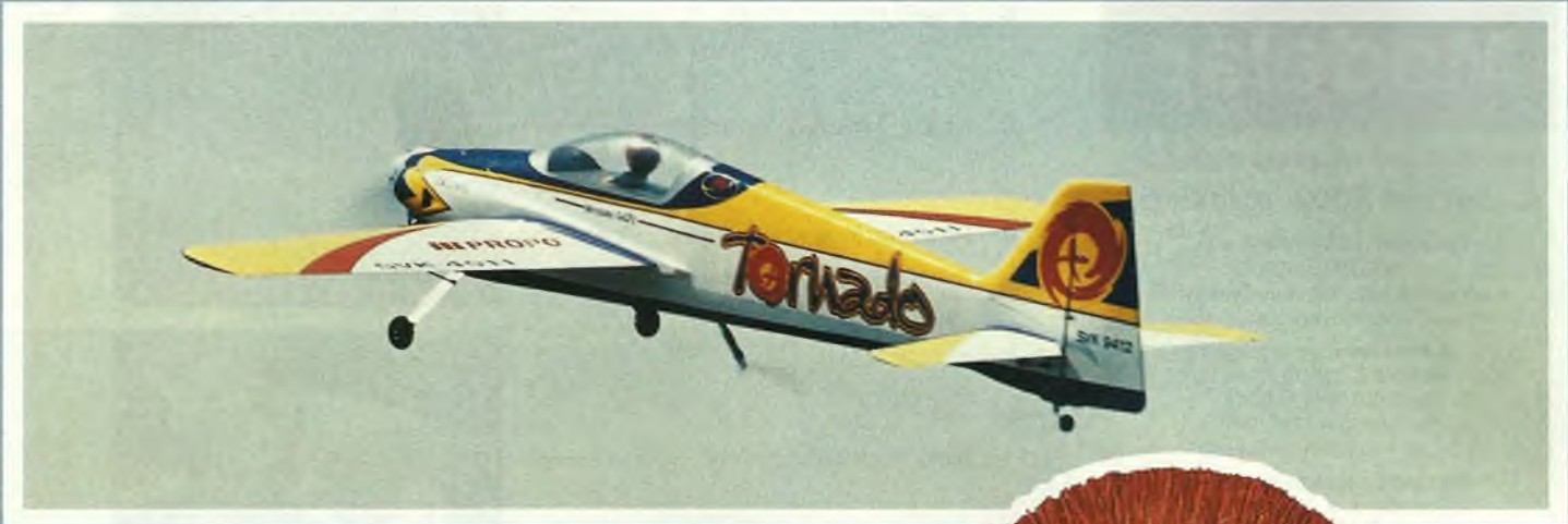
Trenér kategorie F3A Miro Gažo z LKM Levice létá s modelme Tornádo o rozpětí 1940 mm a hmotnosti 4420 g, který je poháněn motorem Jamara 140 R2 a ovládán RC soupravou Graupner
