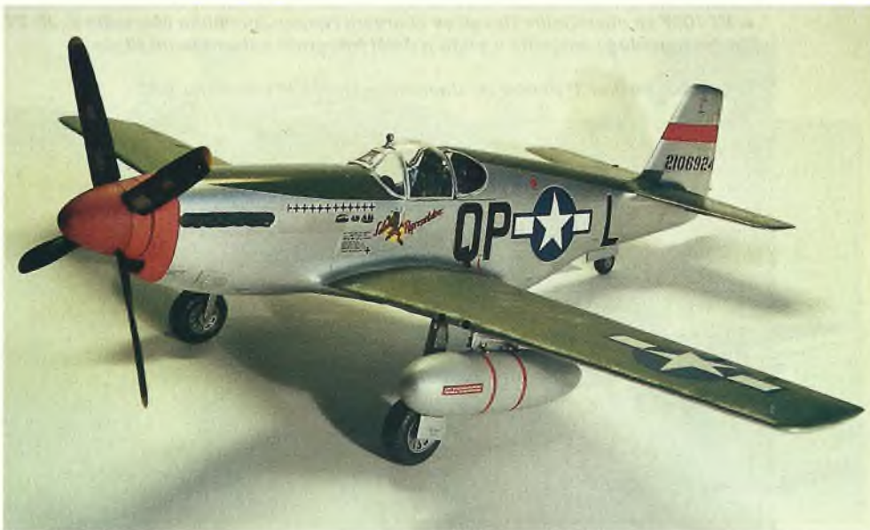
Výsledek „křížení“ starého Mustanga verze P-51C s předkem trupu, kuzelem, vrtulí a podvozkem P-51D od Hasegawy
