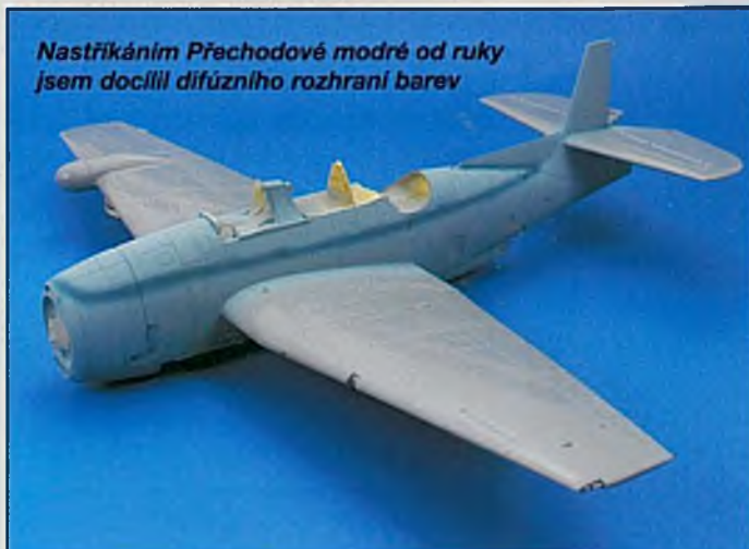
Po nastříkání rozhraní je třeba vzniklé pole vyplnit barvou
