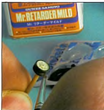
Gumové obruče kolies som natrel štetcem farbou Gunze Tire Black. Keďže farby Gunze rýchlo schnú a sú sami o sebe na štetcet nepoužiteľné, použil som prípravok Retarder Mild Gunze ktorý predlžuje ich dobu schnutia. Pridal som asi 20 % retardéru k obsahu farby. Po použití tohto prípravku farby získajú super vlastnosti na natieranie štetcem a môžu sa v pohode porovnávať aj s farbami Vallejo na štetcet
