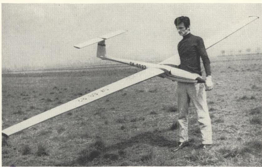
Na snímku J. Vahalíka je maketa sovětského větroně KAI-19 o rozpětí 5040 mm, ploše křídla 120 dm<sup>2</sup> a letové váze 4300 g. Model řízený čtyřkanálovým Tonoxy postavil A. Štverka z LMK Bohumín
