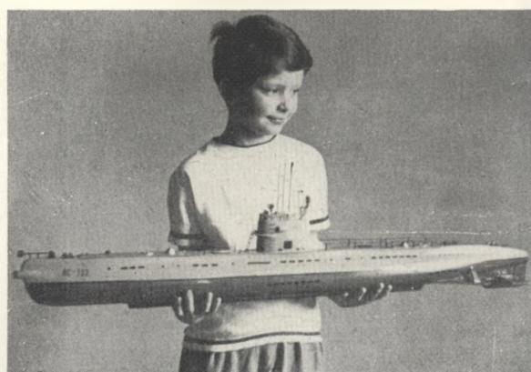
Ponorku Severka se sklolaminátovým trupem o délce 1200 mm zhotobil podle Modeláře K. Čáp z Příbrami. Pohon je dvěma elektromotory Revell, radio 4kanálové Tonoxy
