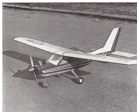
CESSNA 177 – RC maketa amerického letadla na motor 2,5 až 4 cm 3 ; rozpětí 1400 mm, smíšený materiál. (Viz Modelář č. 7/1974) Číslo 63 (s)
