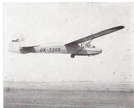
PIONÝR – RC maketa čs. cvičného větroně LF 109 (možnost řízení tří prvků); rozpětí 2245 mm, poměr zmenšení 1:6; smíšený materiál. (Viz Modelář č. 5/1975) Číslo 68 (s)
