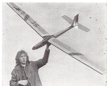
STÍR – vícepovelový RC větroně (řízena směrovka a výškovka); rozpětí 2550 mm, smíšený materiál. (Viz Modelář č. 6/1975) Číslo 69 (s)
