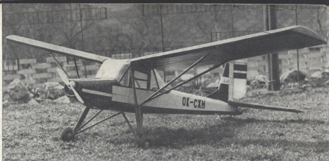
▲ Stavebnici polomakety L 60 Brigádýr o rozpětí 1480 mm vyrábí podnik VEB MOBA Modelle v NDR. Vyfotografovaný model postavil Vladimír Černohorský z Červeného Kostelce; k pohonu použil motor MVVS 2,5 cm 3 a k řízení RC soupravu Mars
