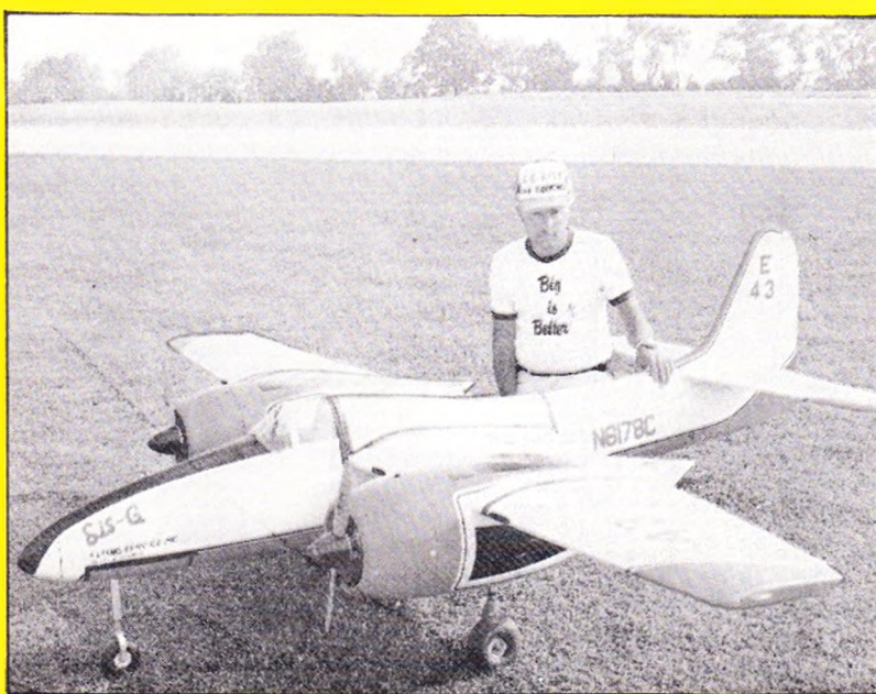
▲ Maketa Tigercat v měřítku 1:5 B. Campbella je poháněna dvěma motory Quadra a řízena RC soupravou Kraft 20 H BB s jedenácti servy. Na soutěži obřích modelů v Luisville (Kentucky) v loňském roce s ni její majitel pry sklídl velké uznání
