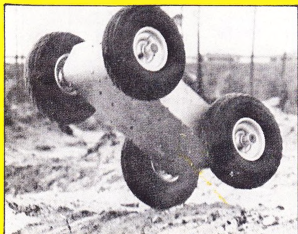
▲ Západoněmecký modelář R. Kunze nazval svůj stroj Geländemonster (Terénní monstrum) – jméno vskutku případné! Pohon modelu zajišťují dva motory Keller 50/10, napájené deseti NiCd články o kapacitě 7 Ah. Jeho celková délka je 630 mm, hmotnost 14 kg a jezdí rychlostí kolem 12 km.h -1
