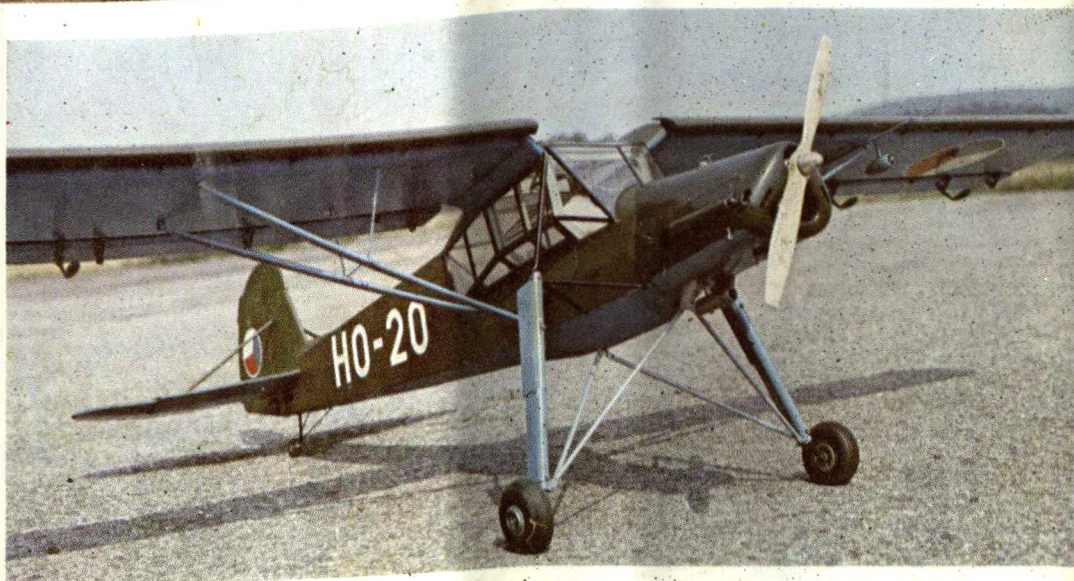
► Dvoumetrová RC maketa K-65 Čáp St. Kačírka z Prahy, poháněná motorem 10 cm 3 , vyniká realistickým letem a funkčním odpružením podvozku
