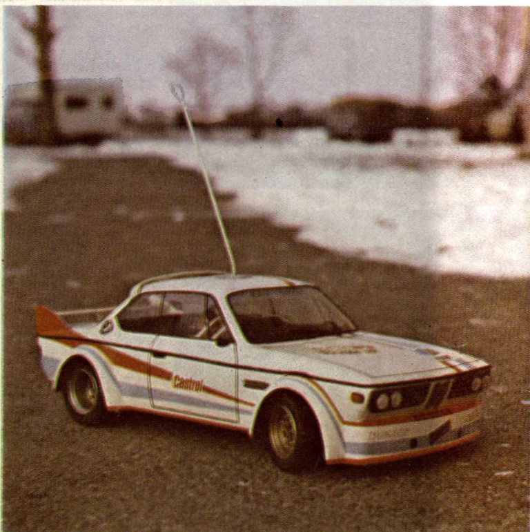
◀ BMW 3.0 CSL v úpravě Luigi zhotovil v měřítku 1:8 Rostislav Ambros z Olomouce. Model je poháněn motorem Mabuchi RS 540E, napájeným dvanácti články NiCd 901 a řízen sovětskou RC soupravou Novoprop
