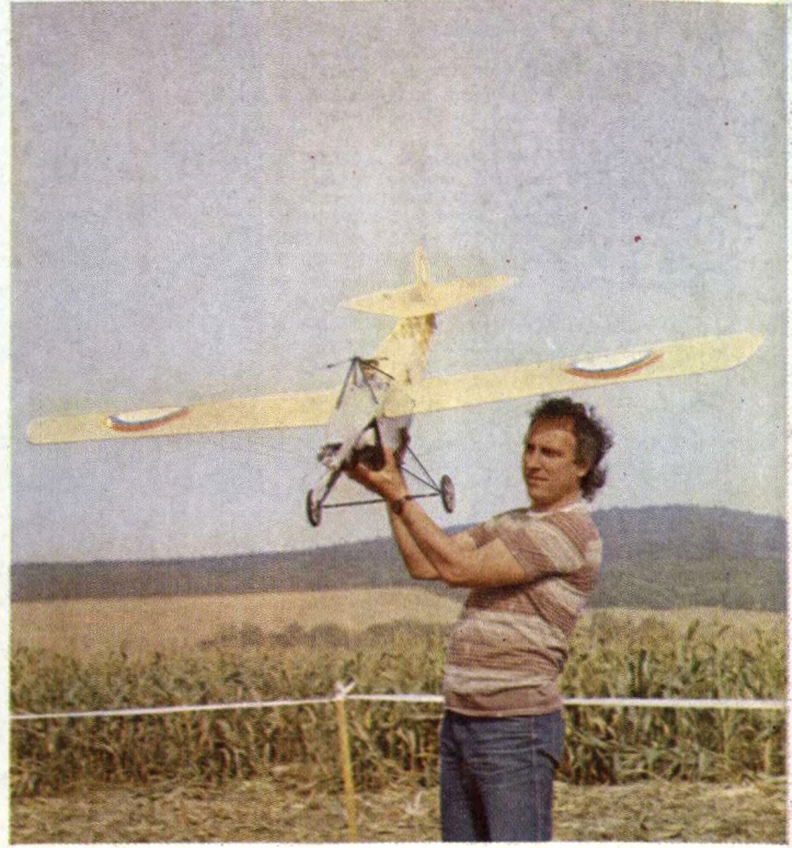
▲ Polomaketa letounu Nieuport z roku 1913 o rozpětí 2130 mm a hmotnosti 4 kg, poháněná motorem MVVS 6,5 cm 3 , je prací Jana Fatky ze Stodu u Plzně
