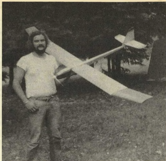
Hmotnost: zdroj (8,4 V/1,2 Ah) 360 g; motor, převodovka, vrtule 230 g; RC vybavení (tři funkce) 280 g; trup 280 g; křídlo 300 g; celkem 1450 g. Plocha křídla 52 dm 2 .
