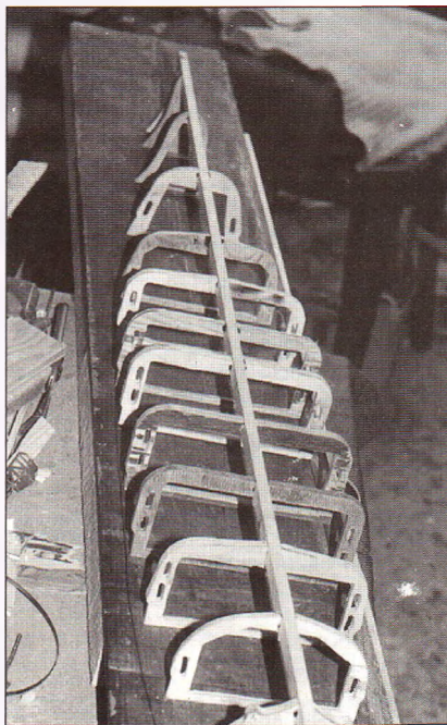
Obr. 7: Pohled na přepážky s kýlem připevněné k pracovní desce
