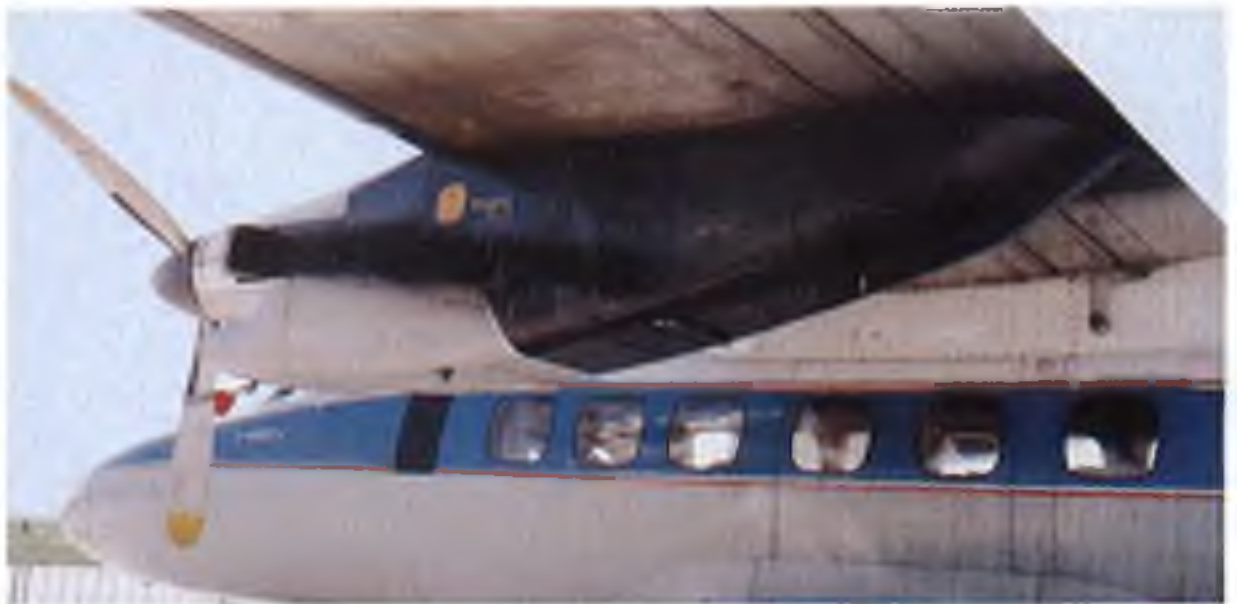
Tvar motorové gondoly je u L-410MA jiný než u vyšších verzí
