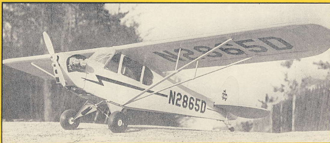
Ze stavebnice západoněmecké firmy Practical Scale postavil RC maketu Piper J-3 Cub o rozpětí 2870 mm a hmotnosti 7500 g poháněnou motorem Quadra (34 cm 3 ) P. J. Hartwig
