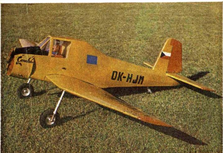
▲ Kolektivní prací členů LMK Pelhřimov je RC polomaketa Z-37 Čmelák o rozpětí 2400 mm, poháněná motorem CS Max 10 cm<sup>3</sup>
