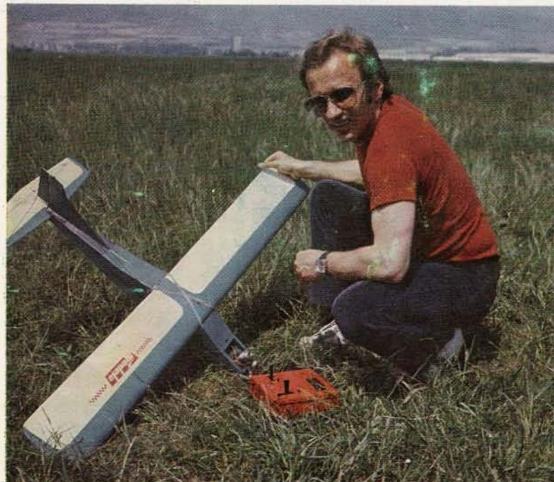
Větroň Hurricane ze stavebnice firmy Simprop má rozpětí 3000 mm, profil E 387, plošné zatížení přibližně 28 g. dm<sup>-2</sup> a řízená kormidla a křídélka ▶
