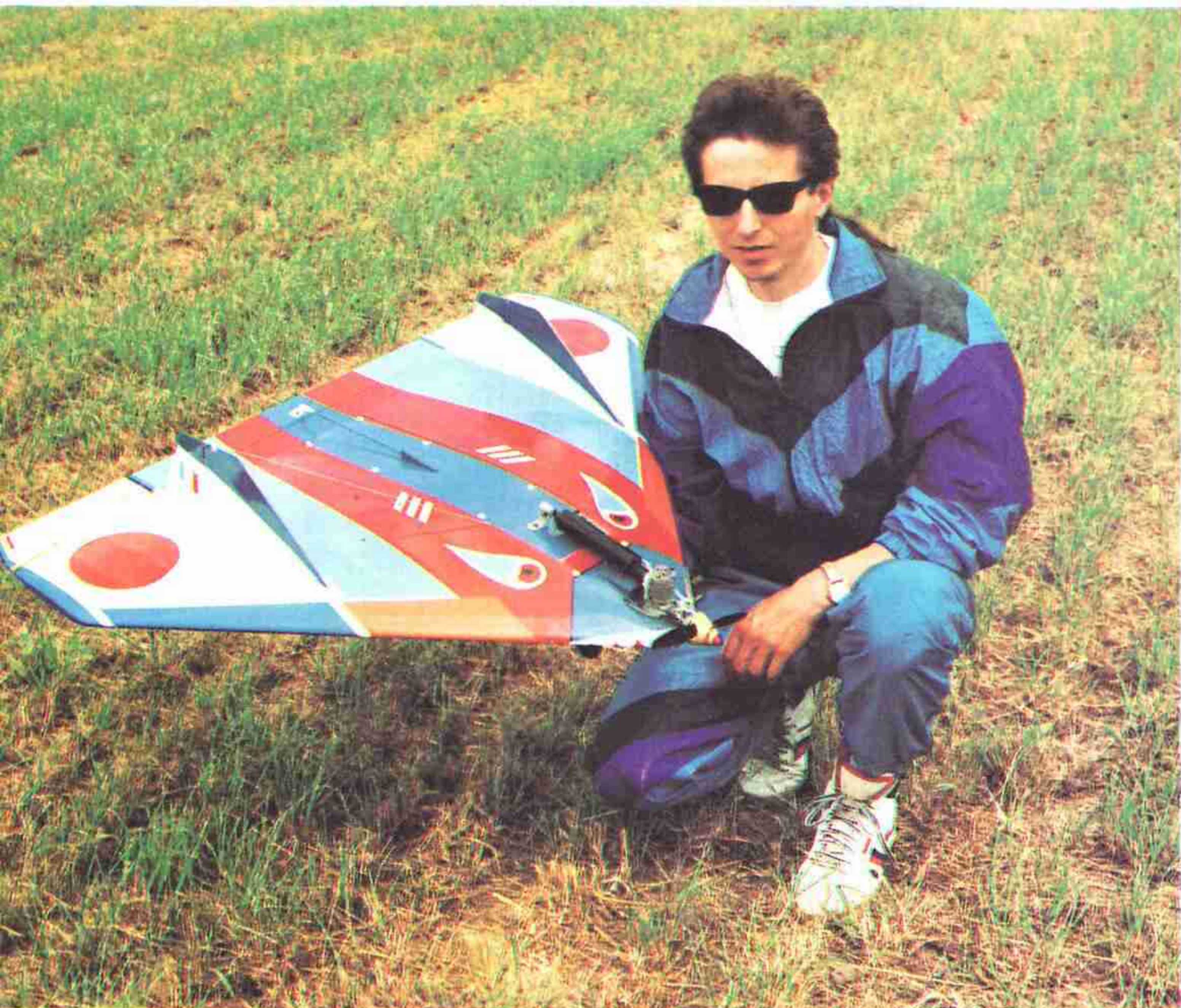
Josef Hyžík z Doloplaz létá na propagačních akcích s RC deltou Hustler XD-7. Model má rozpětí 1120 mm a je poháněn motorem MVVS 3,5 cm 3 . Řízena jsou křídélka, výškovka směrovka spolu s příďovým kolem a otáčky motoru
