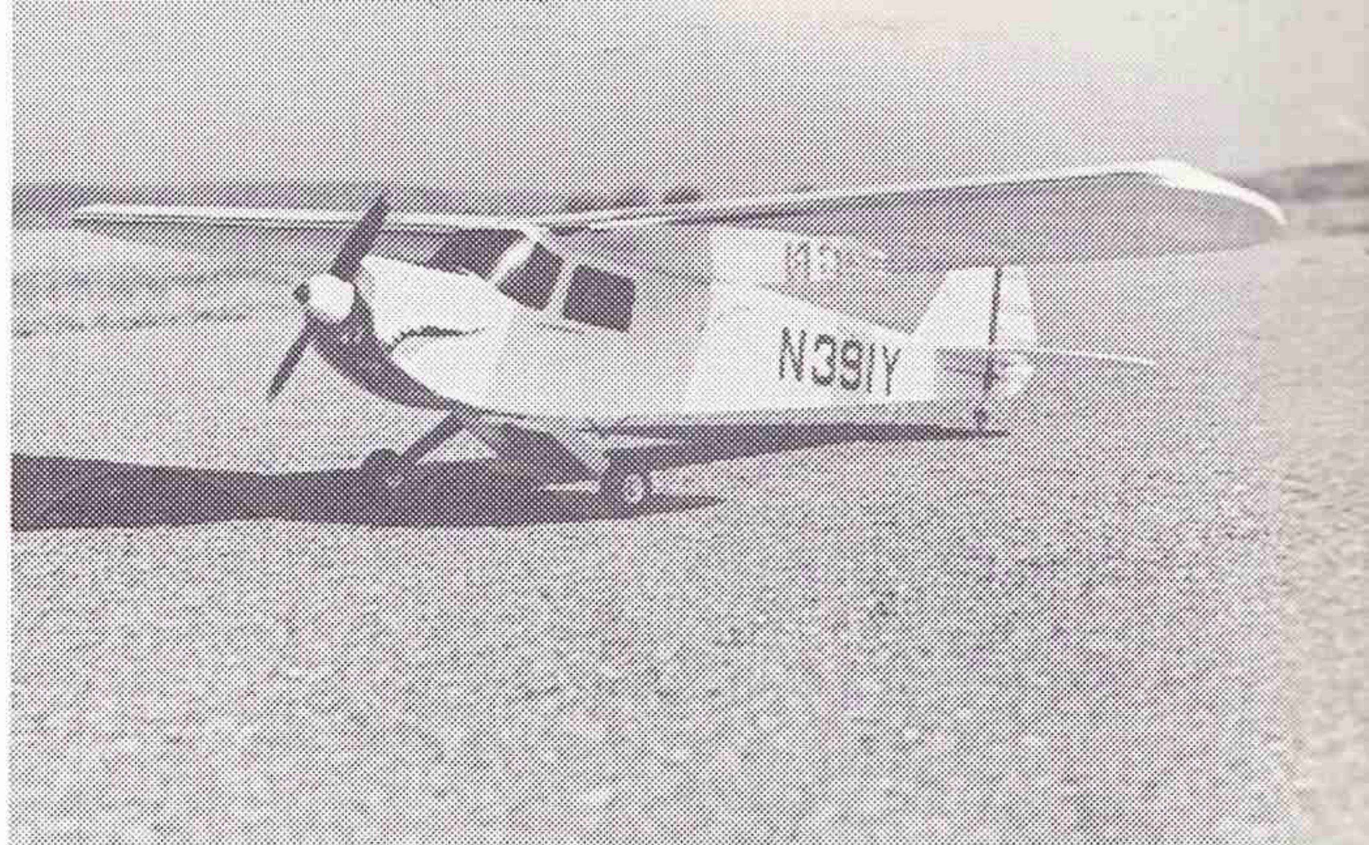
Nesporně roztomilý rekreační RC model si postavil Pavel Hloušek z Náměště nad Oslavou. Při rozpětí 1370 mm a hmotnosti 1700 g je poháněn motorem MVVS 3,5 cm 3 . RC soupravou jsou ovládány směrovka, výškovka a otáčky motoru
