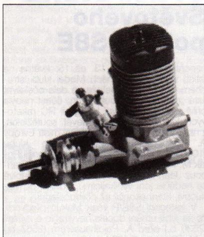
o zdvihovém objemu 12,7 cm<sup>3</sup> konstrukčně vychází z motoru MVVS 10. Má ale větší zdvih (26 mm) a vrtání (25 mm). Maximální otáčky jsou 17 100/min. Dodáván je včetně RC karburátoru. Vtůk je boční, příruba umožňuje přišroubovat tlumič z motoru MVVS 10.
