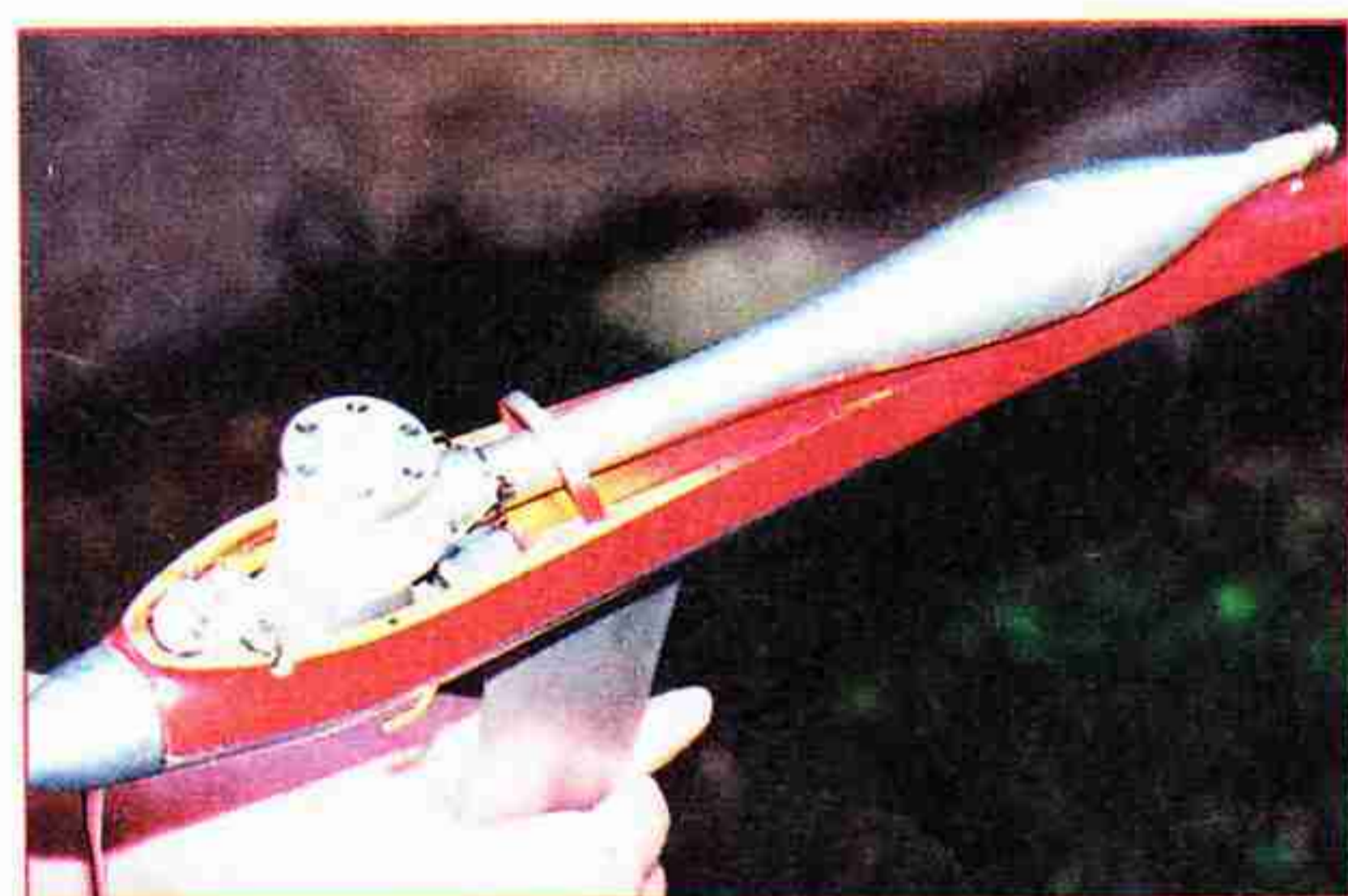
Detail motoru MVVS Speciál s laděným výfukem (motorová kapota sejmutá).
