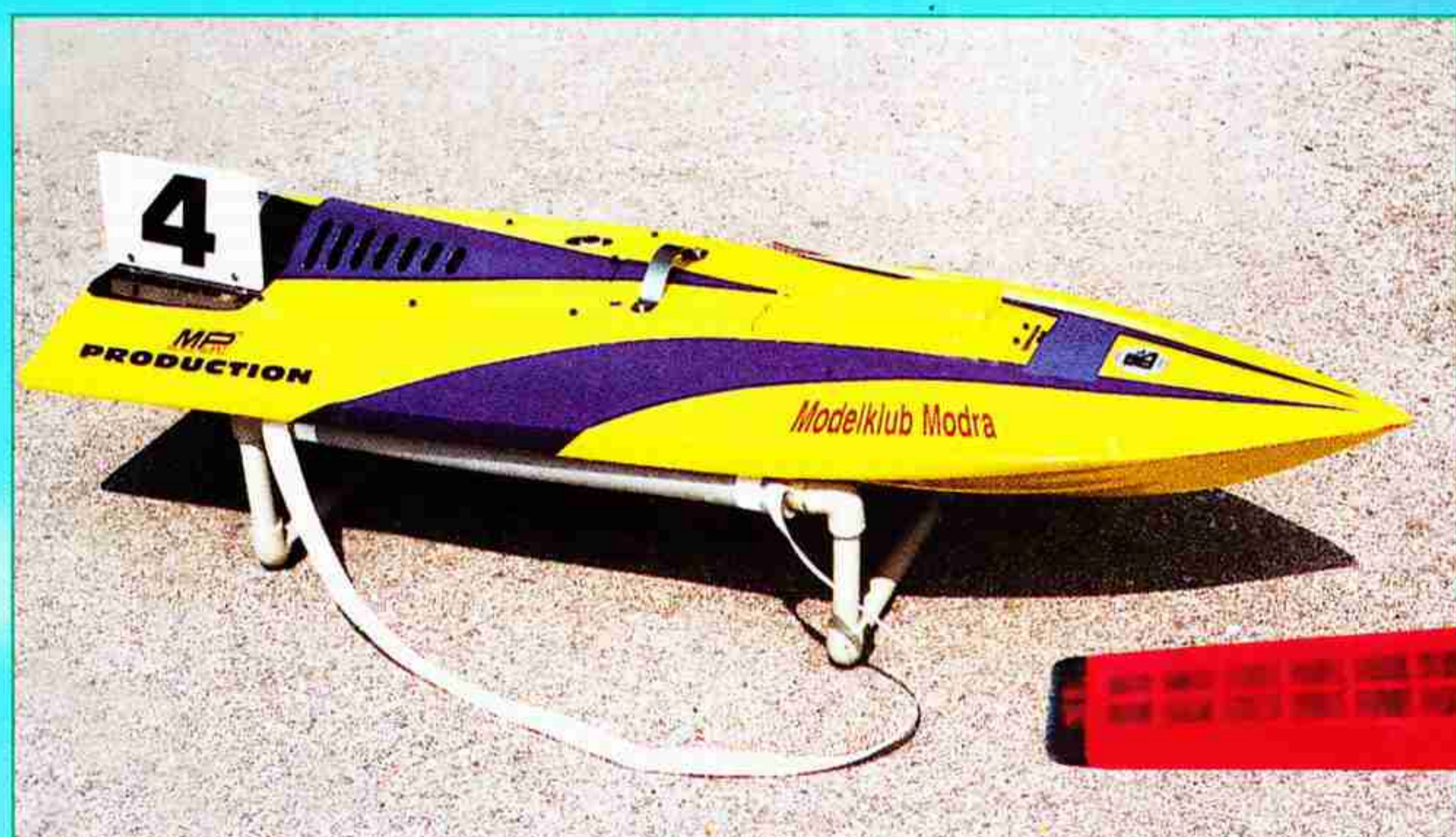
Model třídy FSR F1-V15 si postavil z produkčních dílů firmy MP Production Andrej Vacho z Modelklubu Modra (Slovenská republika). Rychlostní člun je osazen motorem CMB 15 Evo (15 cm 3 ) a řízen RC soupravou Futaba FC-16.
