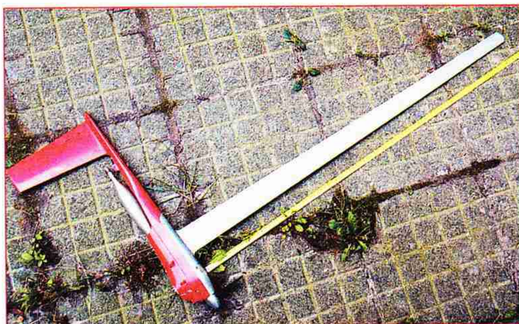
Bizarní tvar rychlostního modelu kateg. F2A (levá polovina křídla, pravá polovina výškovky, jednodílná vrtule. Stavěl a létá M. Obrovský z Brna.
