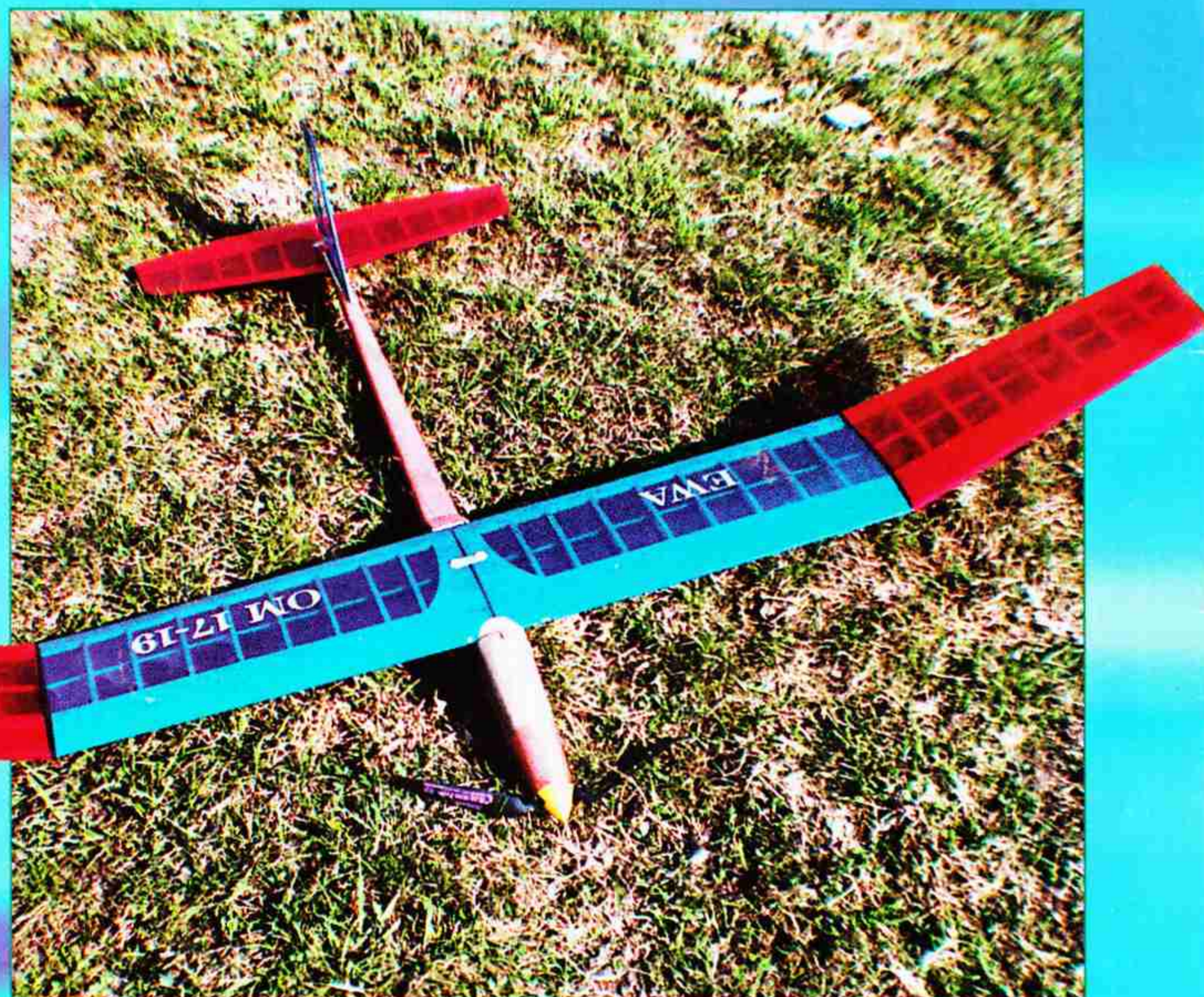
Upravený RC elektrolet Sewa o rozpětí 1650 mm, délce 980 mm a hmotnosti 630 g postavil Rastib Volkomer z LMK Zvolen (Slovenská republika). Pohon Jastron 3:1, vrtule CAM Prop 280/200, regulátor Jes 110, zdroj Aku 7x P 100 AA, RC vybavení Futaba FC-18 (Rx-REX 4, serva Naro Pro).
