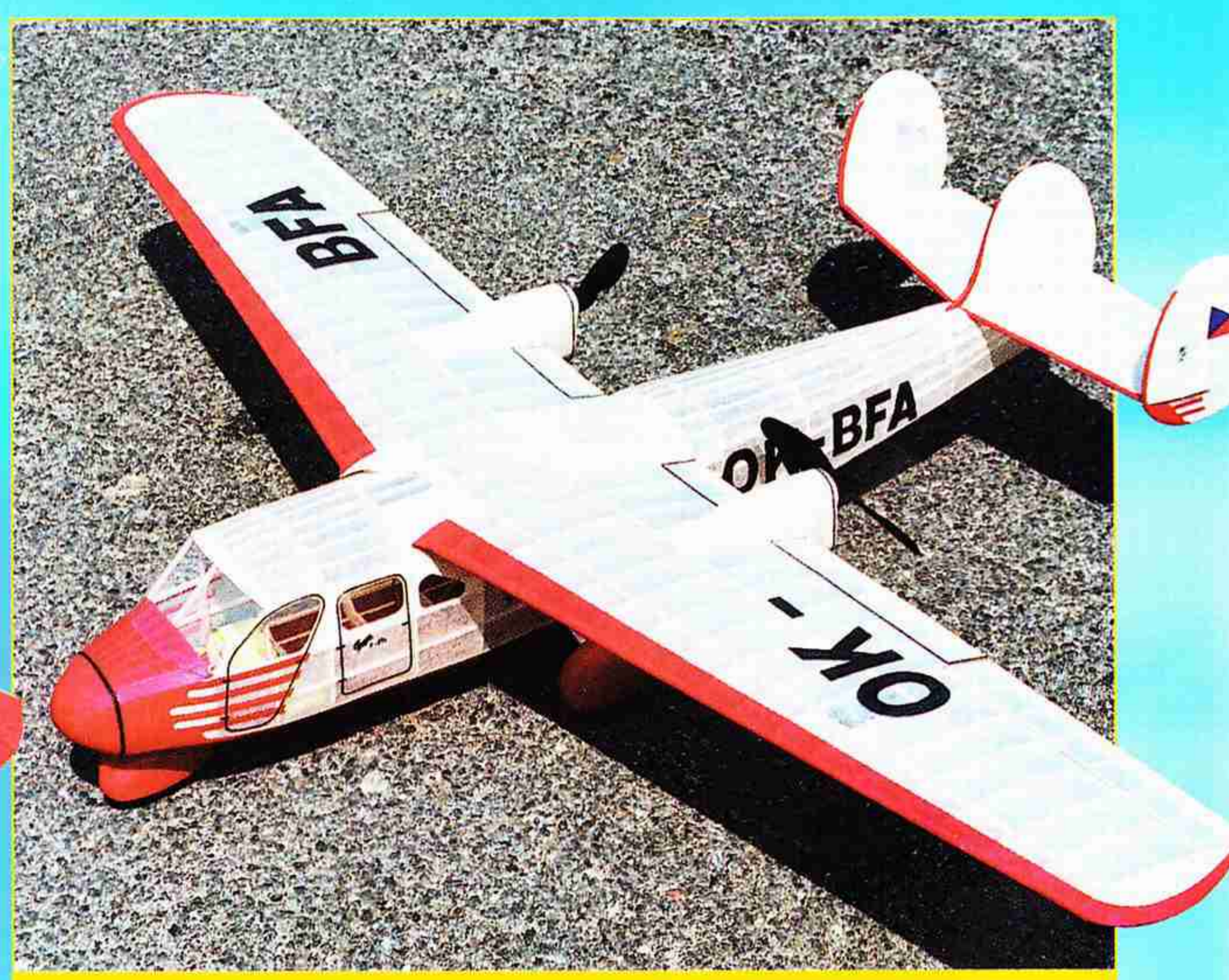
Zajímavý typ s dvěma tlačnými vrtulemi - Praga E-211. RC „elektru“ o hmotnosti 490 g, s předovým podvozkem a trojitou SOP postavil Juraj Tinka.
