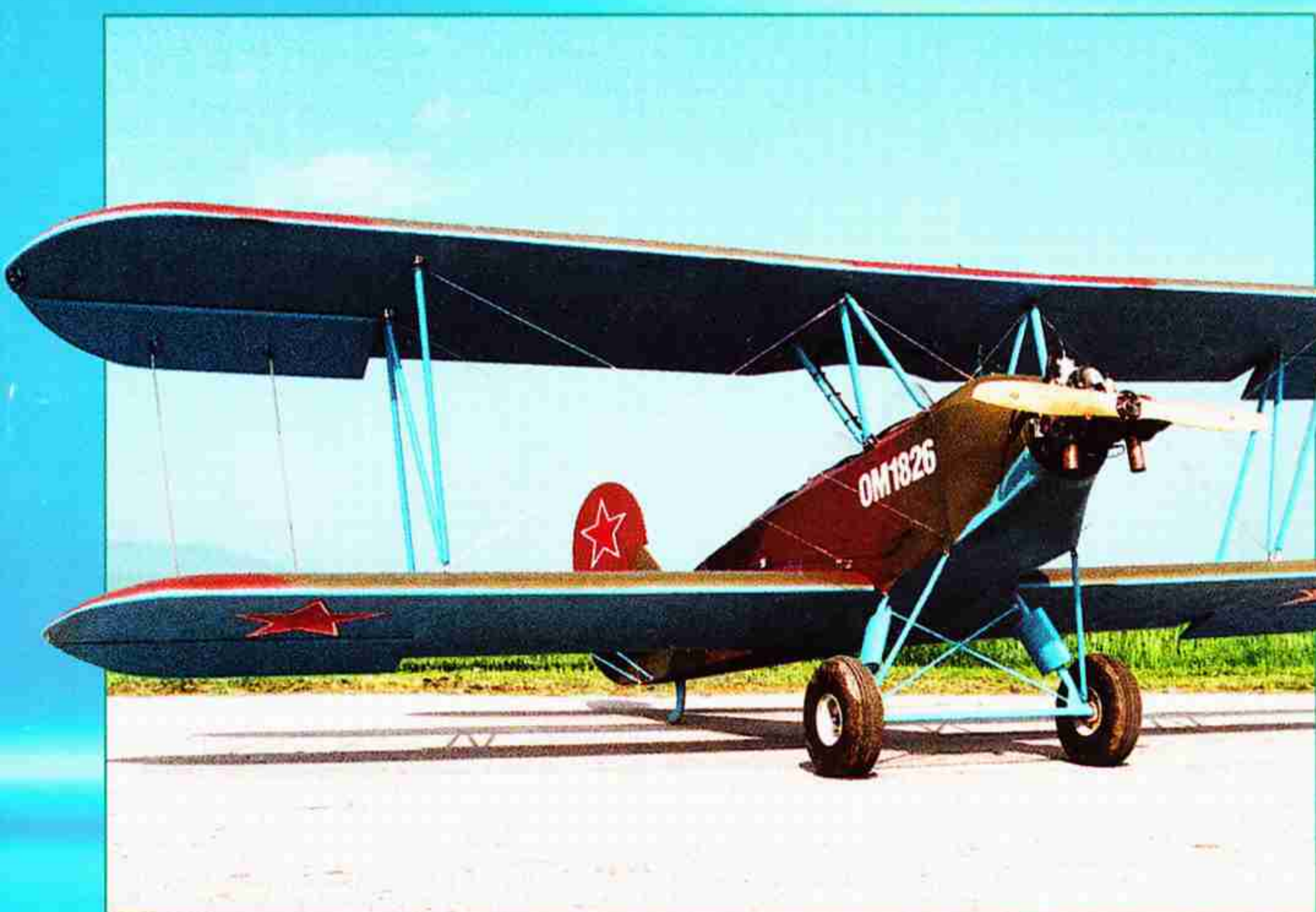
Populární sovětský víceúčelový dvouplošník Polikarpov PO-2 „Kukuruznik“ se dostal do výroby již v roce 1928. Jeho obří RC maketu postavil v měřítku 1:2,7 Michal Vlha (LMK-PKA Liptovský Mikuláš). Zákl. tech. údaje modelu: rozpětí 4860 mm; délka 3400 mm; hmotnost 45 kg; motor A-200 (200 cm 3 ), dvojtálec boxer; RC souprava Futaba FC-16 (viz článek na straně 18).
