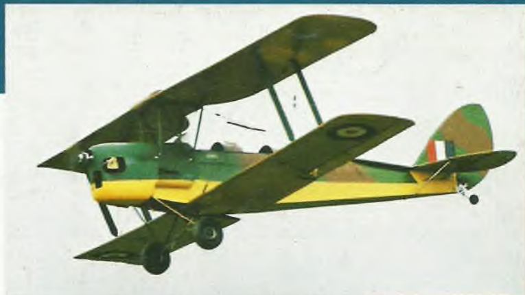
▲ DH Tiger Moth Vladimíra Perníša z LMK Príevídza má rozpětí 2200 mm a hmotnost 7 kg, poháněn je motorem Quadra 32 cm 3
