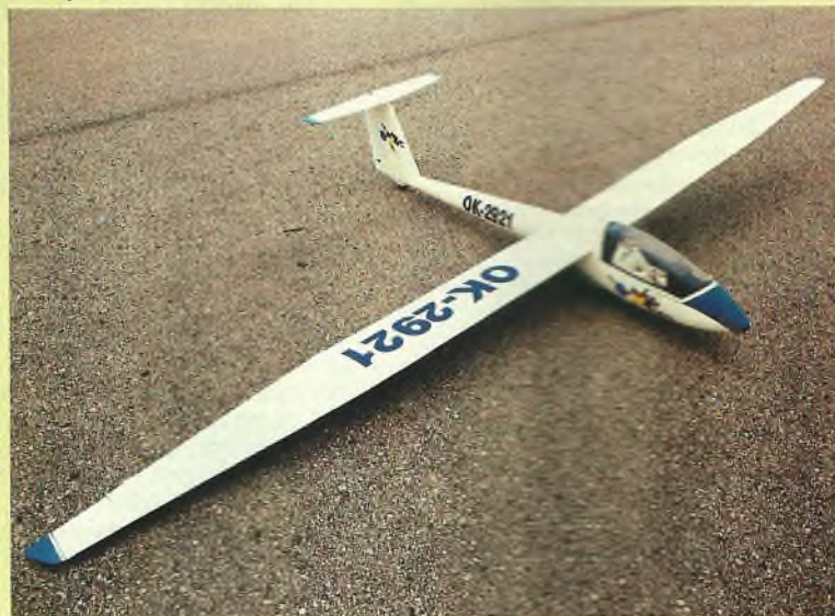
Vladimír Daněk, člen LMK Čmelák Holešov, létá s modelem větroně L-33 o rozpětí 3500 mm a hmotnosti 4700 g, ovládaným RC soupravou Graupner MC-15 ▼
