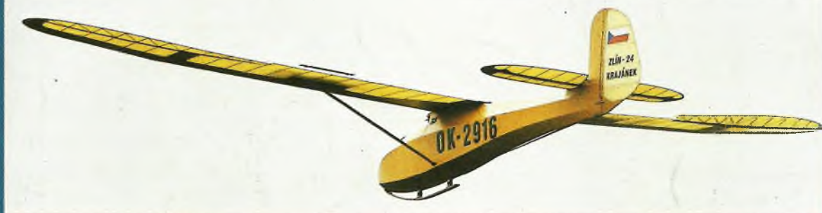
▲ Pohár za největší model si do Rokycan odvezl Jindřich Stejskal za celobalzový větroň Z-24 Krajánek v měřítku 1:1,8. Při rozpětí neuvěřitelných sedm metrů má model hmotnost 24 kg
