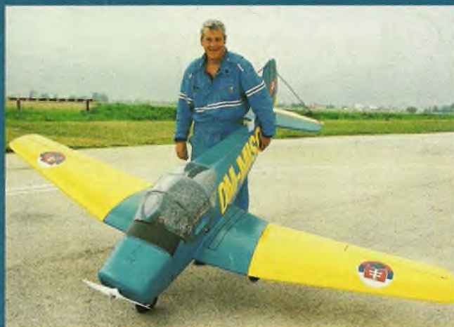
Hlavním organizátorem a duší celé akce byl Miško Vlha, člen LMK PDA Liptovský Mikuláš. Létal s modelem M-2 Skaut v měřítku 1:2,8 o rozpětí 3340 mm a hmotnosti 14,5 kg
