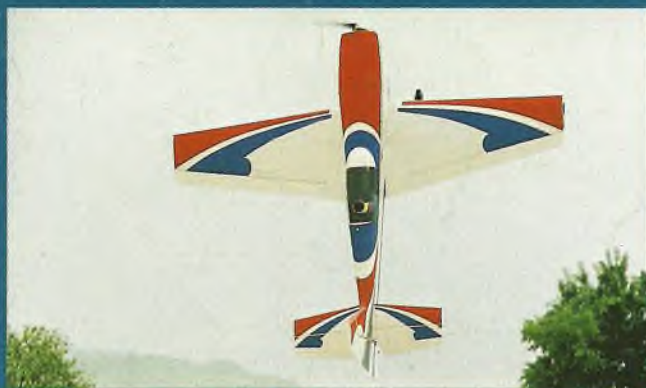
Jano Hlebaško z Košic dokázal obraty svého modelu akrobatického speciálu Extra 300 o rozpětí 3000 mm přivést do varu všechny diváky. Model o hmotnosti 14,5 kg pohání motor ZD2 160 Boxer ovládaný RC soupravou Futaba FC-28, stejně jako směrovka, výškovka, křídélka a vztlakové klácky
