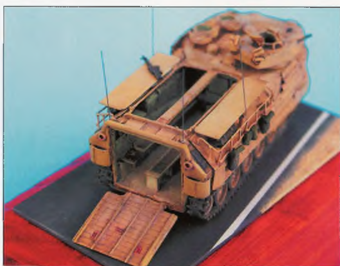
Práce za jedno odpoledne. Licování dílů je dobré a stavba tak rychle ubývá. Nově zhotovené poklopy a blatníky jsou z hliníkového plechu
