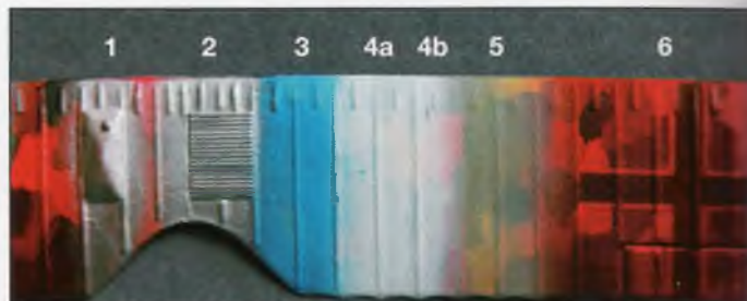
Zkouška kryvosti: 1 Aluminium metallic (hliník), 2 Steel metallic (ocel), 3 bílá s příměsí modré Vallejo, 4a bílá ve dvou vrstvách, 4b bílá výrazně ředěná, 5 Steingrau (šedá) ředěná, 6 Karmínově červená – dvě vrstvy
