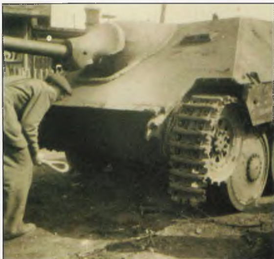
Tentýž stroj (pozice 3) již s rozpojenými pásy (pro lepší manipulaci s vozidlem), litým starším typem řídicího průzoru a tažnými háky rovněž staršího provedení
