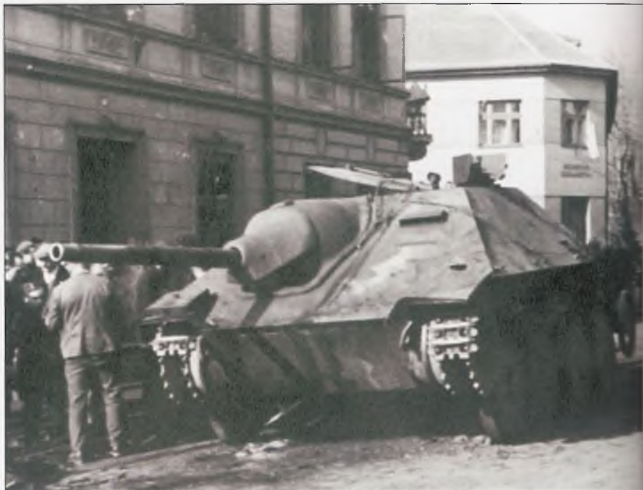
Pásky na vozidle (pozice 4) jsou maximálně zkráceny, patrný je plechový kryt průzoru řidiče i jeho klamné maskování pruhy černé barvy (3. výrobní varianta)
