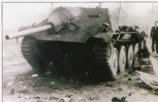
Dobře patrný litý průzor řídicího (pozice 1), starší typy tažných háků, kryt kanónu nestandardní
