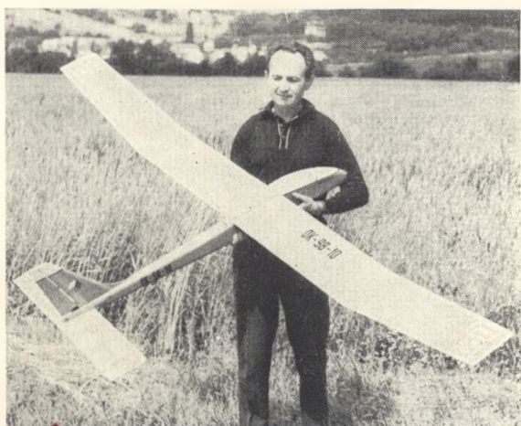
RC větroň Merlin II Jozefa Cerhy z LMK Zvolen. Rozpětí 2900 mm, délka 1350 mm, nosná plocha 60,9 + 12,3 \text{ dm}^2 , profil křídla E-385, profily ocasních ploch souměrné, váha 1750 g. Ovládána jsou obě kormidla čtyřkanálem Tonox
