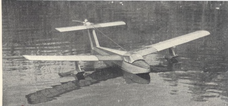
Jaromír Bílý z Mělníka pokračuje ve své „tlačné“ koncepci RC modelů. Obojživelník o rozpětí 1300 mm a váze 900 g vzlétá z vody s motorem Pfeffer 1 \text{cm}^3 . – Máme vydat plánek?
