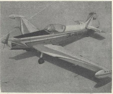
**Z 526 AS** – upoutaná maketa čs. letadla na motor 5,6 cm<sup>3</sup>; rozpětí 1435 mm, smíšený materiál.
