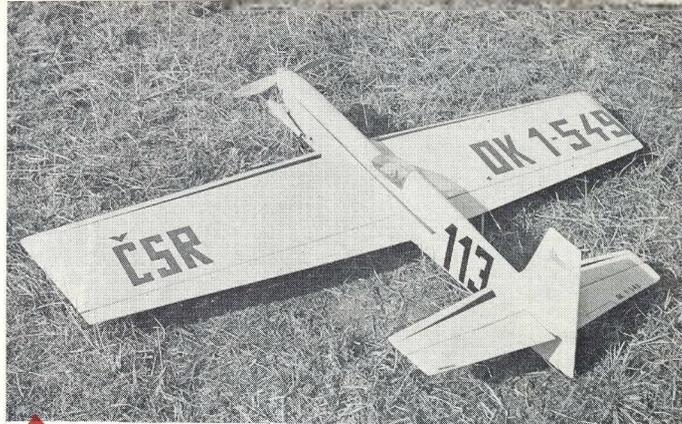
Konstruktivně zdařilý a úhledný je nový U-akrobat Vratislava Kokeše z LMK Praha 8. Má rozpětí 1380 mm, pohon motorem Veco 5,6 cm<sup>3</sup> a váží 1240 g
