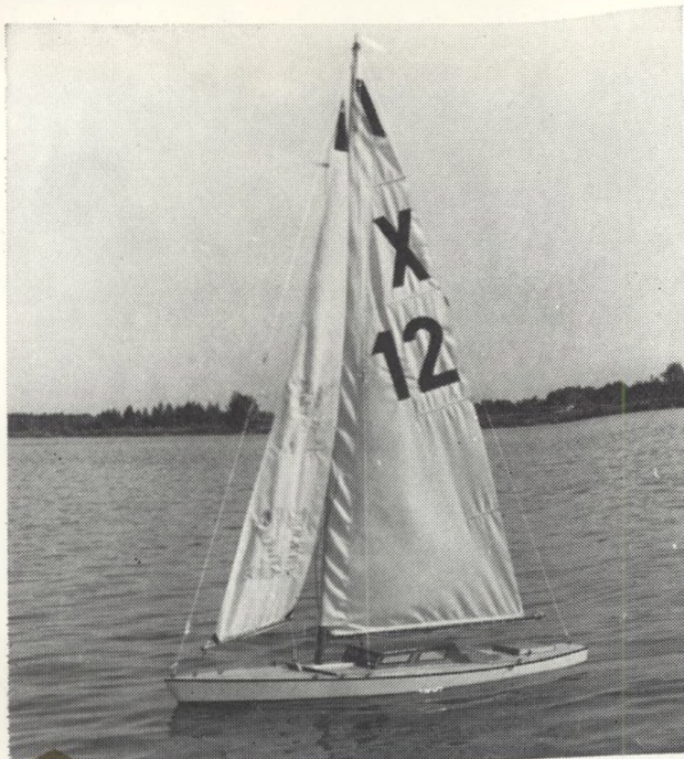
Plachetnici Babetta (plánek Modelář č. 56s) zvětšenou tak, aby odpovídala pravidlům třídy F5 DX, si postavil J. Fořt z Olomouce. I při řízení pouze kormidlem je loď dobře ovladatelná
