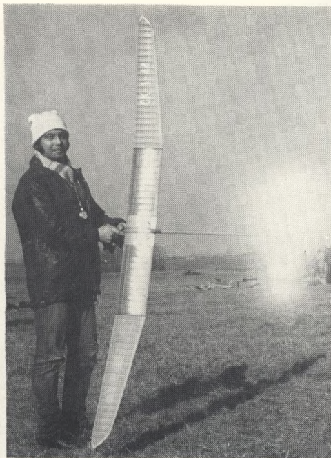
To, co není na snímku vidět, je vodorovná ocasní plocha na A-dvojce mistra sportu Pavla Dvořáka z LMK Praha 4. Potah stříbřitou nažehlovací fólií umožní jednak dosažení menší hmotnosti, jednak výrazně zlepšit viditelnost modelu – odlesky jsou vidět na velkou vzdálenost
