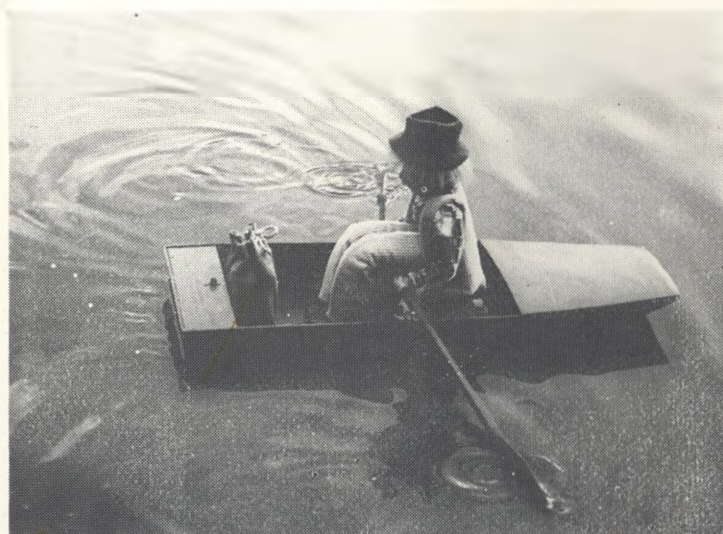
Rádiem řízený rybář vzbudil zaslouženou pozornost při mezinárodní regatě v Jevanech. Předvedla jej modelářská rodina Nekvapilova; byl opravdu poháněn vesly a jejich různým pohybem i zatáček
