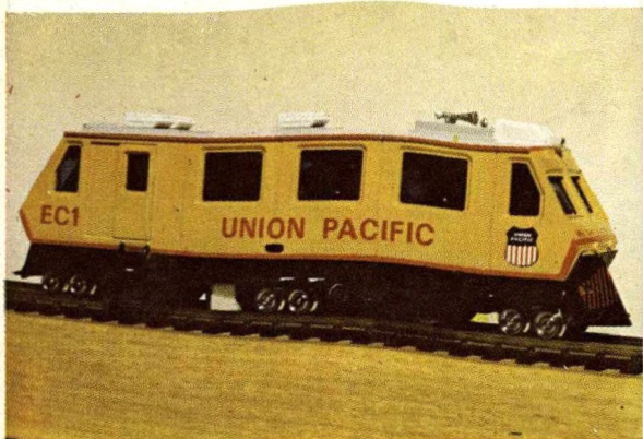
▲ Předloha tohoto modelu – Plasser & Thener EM 80 – je určena ke kontrole železničního svršku. Podvozek modelu (ve velikosti HO) je opatřen hranolem plstí, navlhčovaným z nádrže čistou naftou, který při jízdě vyčistí koleje a zajistí tak spolehlivý provoz
