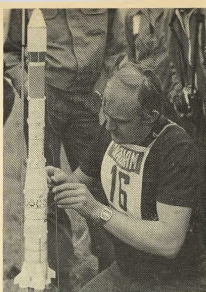
Maketa Ariane Petra Horáčka z Adamova. Prateckový stabilizátor na prvním stupni, druhý stupeň s rozklápěcími plastickými stupni je zažehován elektronickým časovačem
