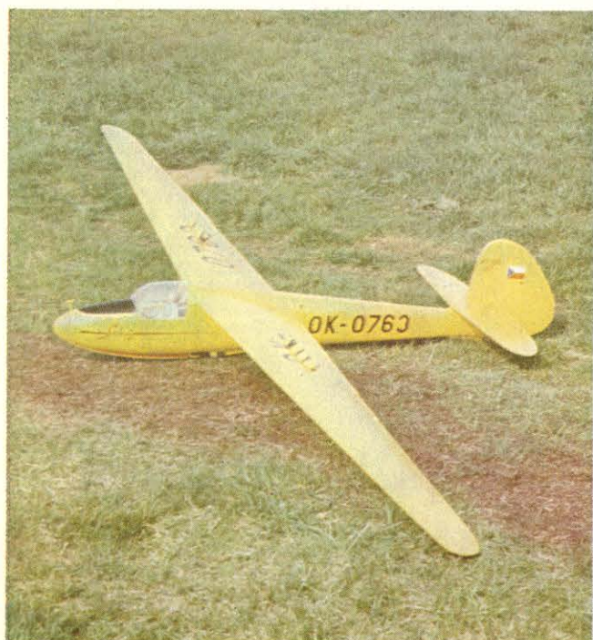
◀ RC maketa Z-125 Šohaj 2 v měřítku 1 : 4,5 Josefa Petráne z Rožmitálu pod Třemšínem má rozpětí 3340 mm, profil FX 60-126/100 a výborné letové vlastnosti (shodné s předlohou)
