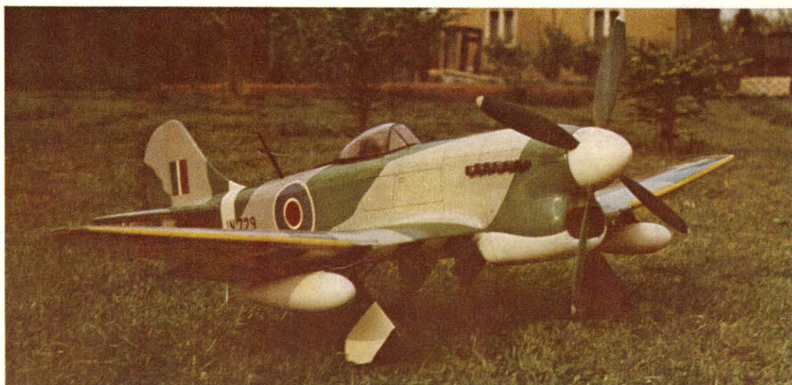
► Upoutaná maketa Hawker Tempest M. Švába z LMK Broumov je poháněna „desítkou“ Tono; kromě výškovky jsou ovládány otáčky motoru a vztlakové klapky
