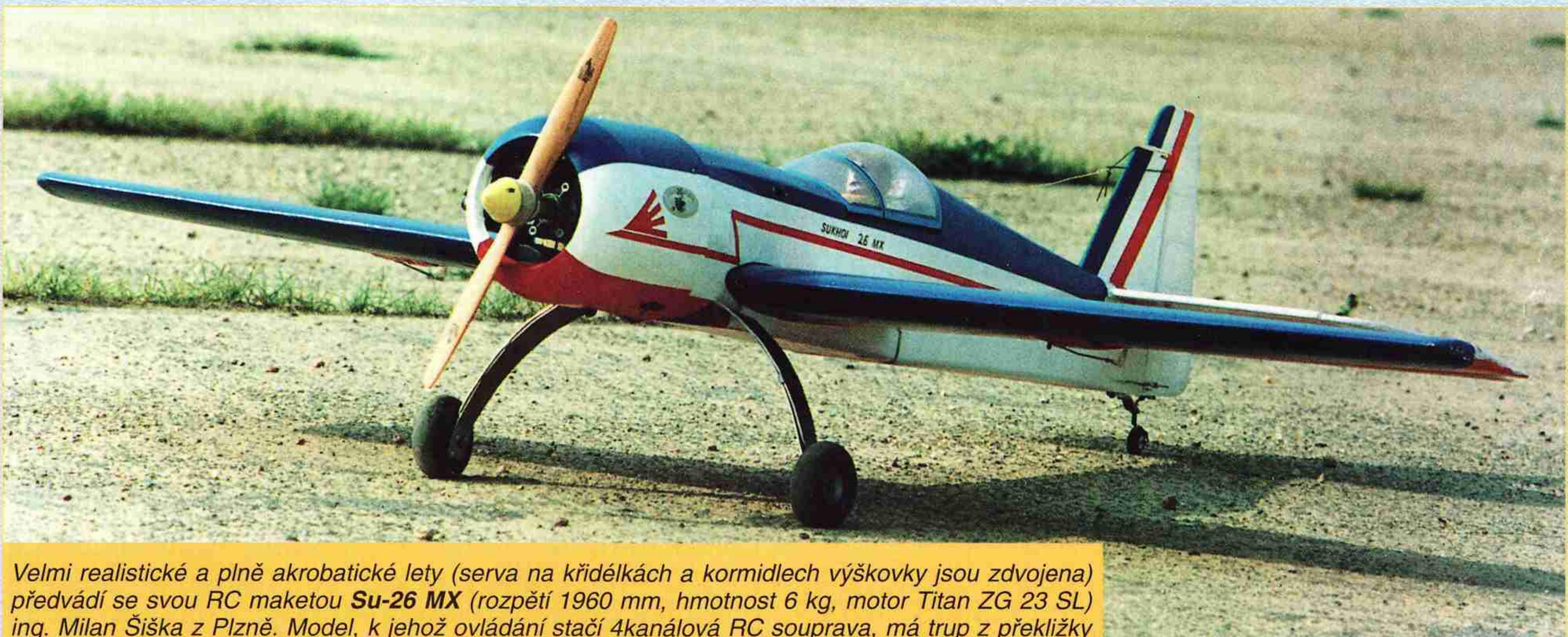
Velmi realistické a plně akrobatické lety (serva na křídélkách a kormidlech výškovky jsou zdvojená) předvádí se svou RC maketou **Su-26 MX** (rozpětí 1960 mm, hmotnost 6 kg, motor Titan ZG 23 SL) ing. Milan Šiška z Plzně. Model, k jehož ovládání stačí 4kanálová RC souprava, má trup z překližky a balzy, křídlo je polystyrenové s dvojím potahem z hnědé lepicí pásky, křídélka balzová.
