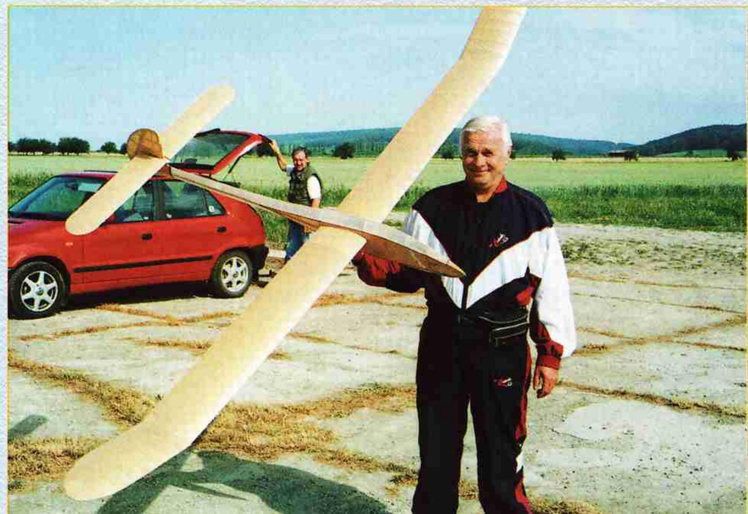
Na soutěži odtimerů v Hořicích předvedl Jaroslav Netáhlo krásný větroň **Vážka**, který původně zkonstruoval v roce 1953 Míla Vaněk z Berouna. Přestože jde o nový model je postaven klasickým způsobem z dřevěných nosníků a překližky, potažen je původním papírem Kablo. RC soupravou se ovládá směrovka a výškovka.
