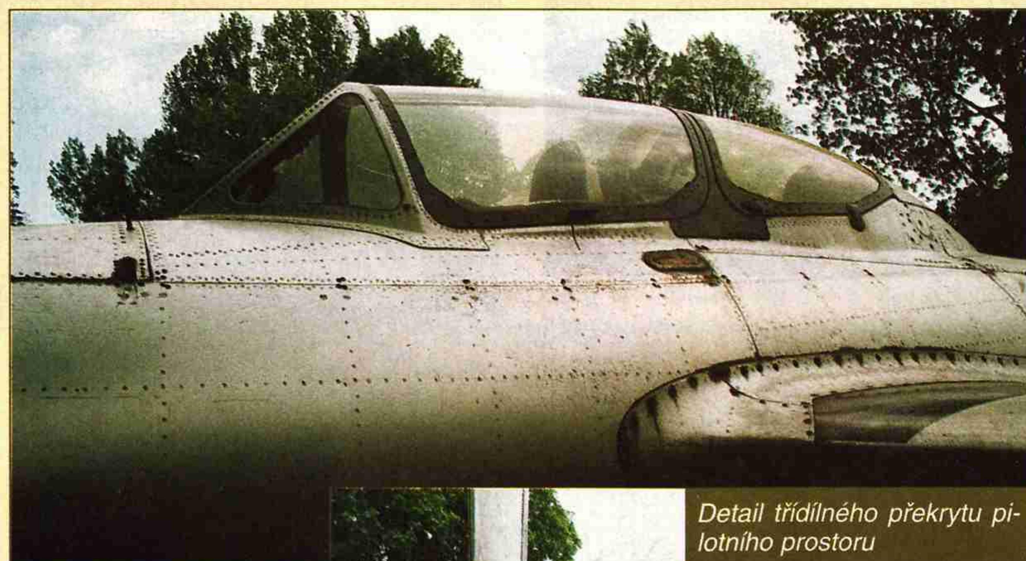
Detail třídielného překrytu pilotního prostoru
