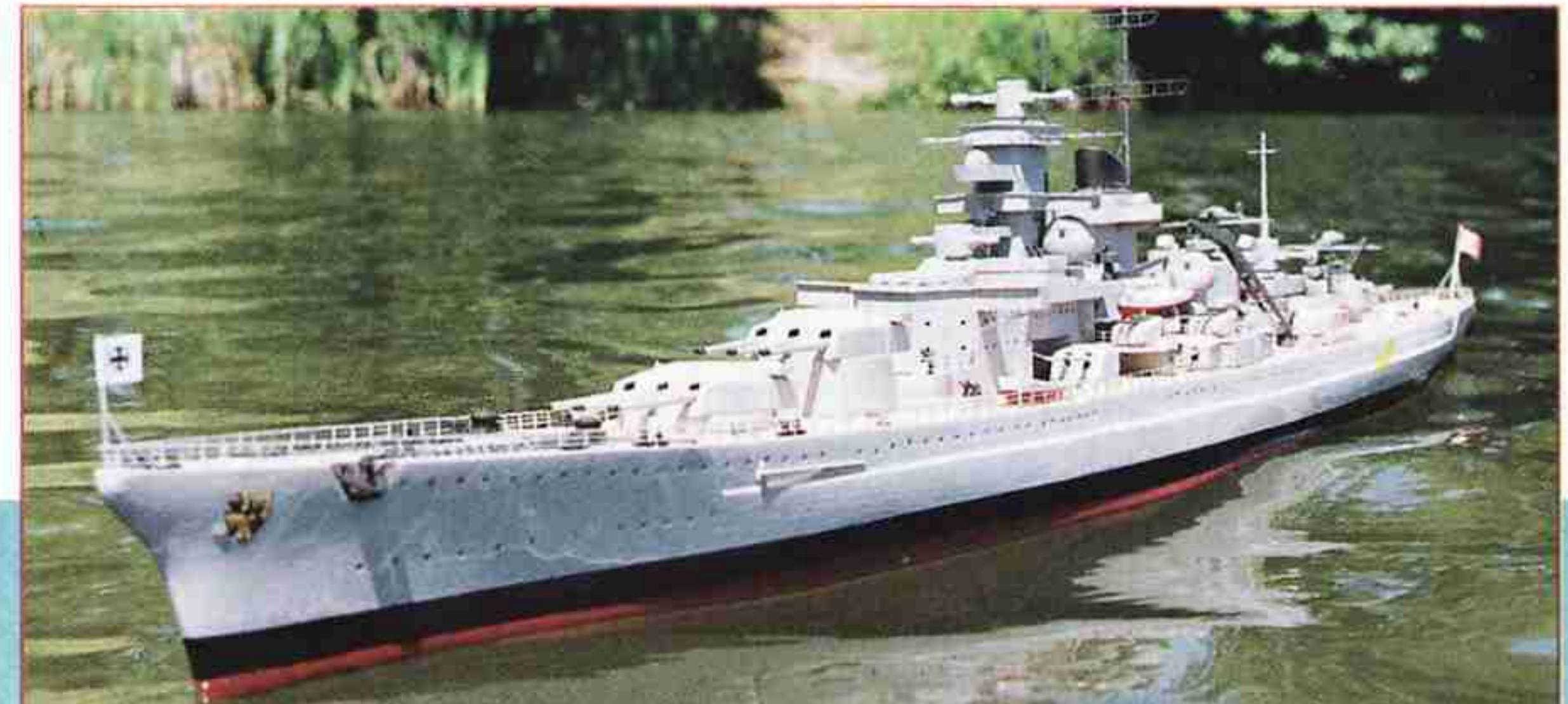
Štefan Adámik z Model klubu Prievidza postavil RC maketu německého bitevníku **Gneisenau** z roku 1936 v měřítku 1:200 (délka 1117 mm, šířka 150 mm, hmotnost 4200 g, el. motor Speed 600, RC souprava Modela FM 27).
