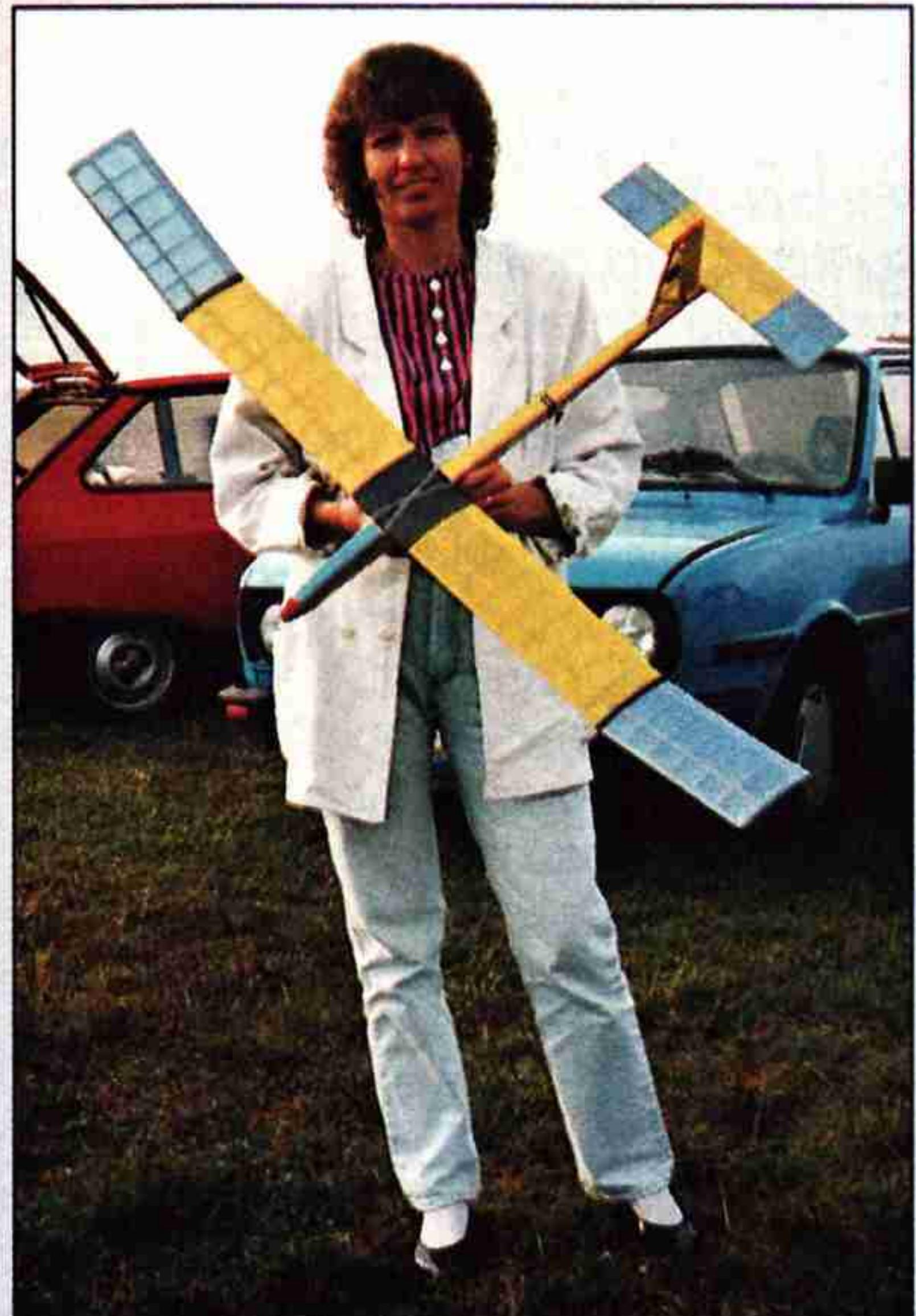
Jak už název napovídá, bude tato část věnována potahování. Na potah modelů letadel se používají různé druhy materiálů. Jsou to buď speciální potahové papíry Mikalenta, Modelspan, Japan apod., nebo tkaniny, např. Monofil a Upraca. V současné době se k potahování velmi často používají také fólie. V minulosti to byl nejčastěji papír Kablo a hedvábný papír. S papírem Kablo se můžete setkat ještě dnes na některých historických modelech.
