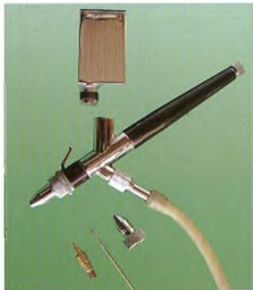
Klasickým zástupcem jednočinných stříkacích pistolí je Aerograf, kdysi dodávaný s výměnnými tryskami, náhradní jehlou a větším zásobníkem barvy
