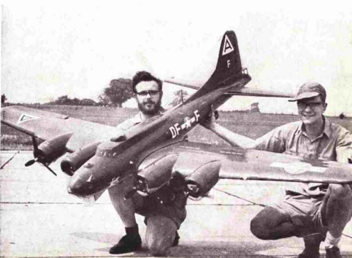
R/C maketu bombardéru B-17 postavili britští modeláři Norris, Harrison a Alexander z klubu v Bristolu. Model v měřítku 1 : 12 pohánějí dva motory K & B 45 (dvě vrtule nejsou funkční), jsou ovládána kormidla, křídélka a přípusť motorů
