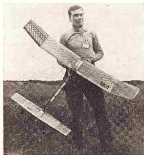
Mistr světa 1965 Dall'Oglio s jímým ze svých modelů stejné koncepce, ale s geodetickou konstrukcí i na křídle a s trupem o kruhovém řřezu. Tohoto modelu použil při rozlřdování.
