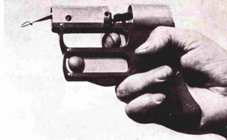
▲ Pistolová řídicí rukojeť pro rychlostní U-modely. Konstruoval rakouský modelář Bugl (vyrábí též motory), používá ji jeho krajan Freundt
