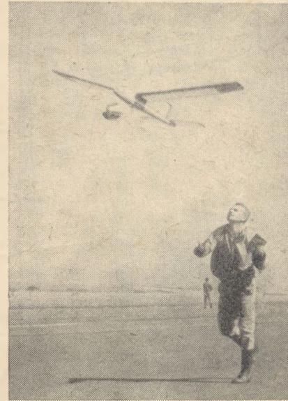
K. Konvalinka z LMK Nižbor u Berouna létá s upraveným jednokanálem STANDARD (podle plánu Modelář č. 33s); výškovku upevňuje přímo na trup
