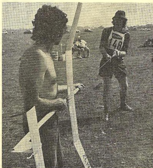
Anglický modelář R. Bailey létal v zastoupení za novozélandského Alana Mc Donalda. Model s celobalsovým potahem má neobvykle nadsazenou výškovku na směrovce
