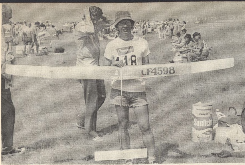
Větroň, s nímž Kanadčan A. de Melo létal na MS 1973, měl tuhý potah křídla a turbulentní vlákno před náběžnou hranou
