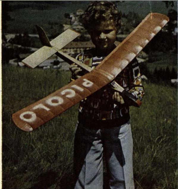
▲ Model Picolo ze stavebnice VD IGRA upravil na RC větron ř. ing. Metoděj Švarcák z Bystrice nad Pernštejnem. Směrovka je ovládána magnetem, připojeným k upravenému přijímači Brand Hobby, napojenému ze dvou článků NiCd 225. Hmotnost modelu je 170 g
