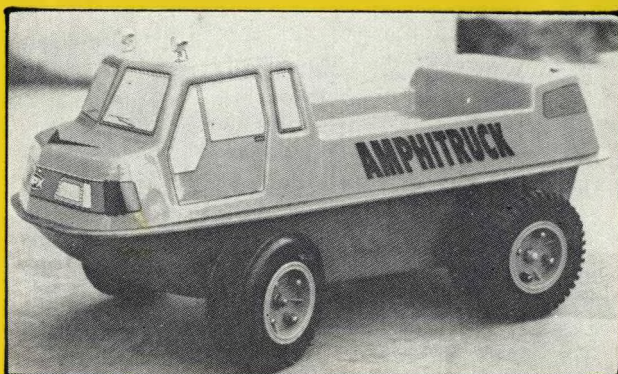
▲ Obojživelné terénní vozidlo Amphi-Truck ze stavebnice firmy Multiplex zdolá bez potíží i stoupání 50 %. Při plavbě je poháněno lodní vrtulí uloženou v tunelu trupu. Hmotnost modelu, vybaveného karosérií z plastické hmoty, je zhruba 3,5 kg
