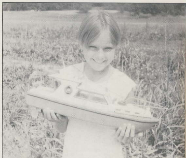
▲ Jan Štefl z Jihlavy si převážně z balsy postavil polomaketu jachty o délce 540 mm. Model, poháněný lodním kompletem z bývalého SSSR a ovládaný RC soupravou Mars II, je opatřen časovačem a funkční houkačkou
