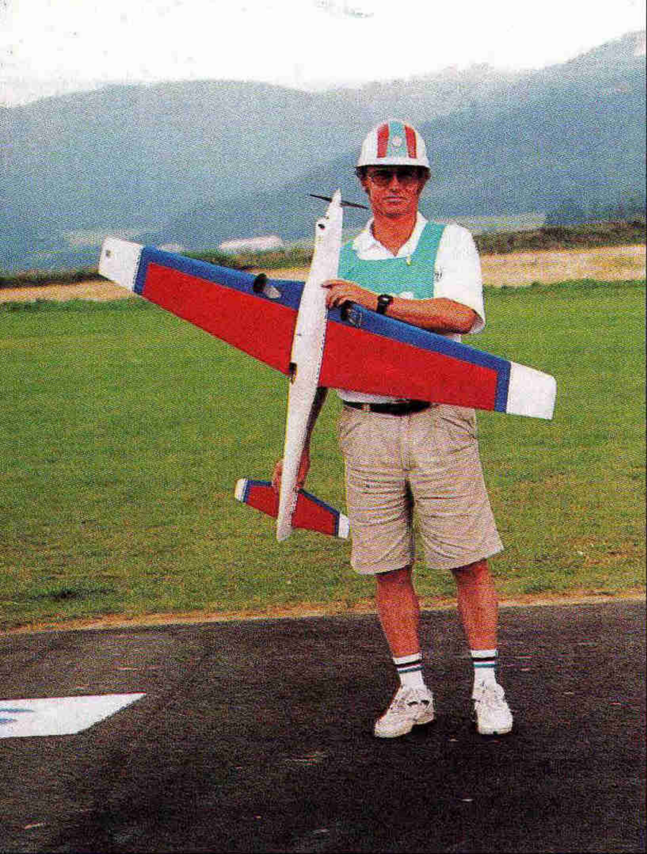
Model Z-37 Čmelák Rudolfa Helmera z Prahy (konstrukce M. Holovlaský) má rozpětí 2750 mm, délku 1800 mm a hmotnost 9,2 kg. Osazen je motorem Titan ZG-62. RC soupravou je ovládána směrovka, výškovka, křídélka, vztlačové klapky, motor a „vypínač“ na vlečení jiného modelu. Pro stavbu byla použita balza, překližka, překližka z bedniček a k potažení materiál Upraca. Povrchová úprava je provedena nitroemallem a akrylátovým lakem.
