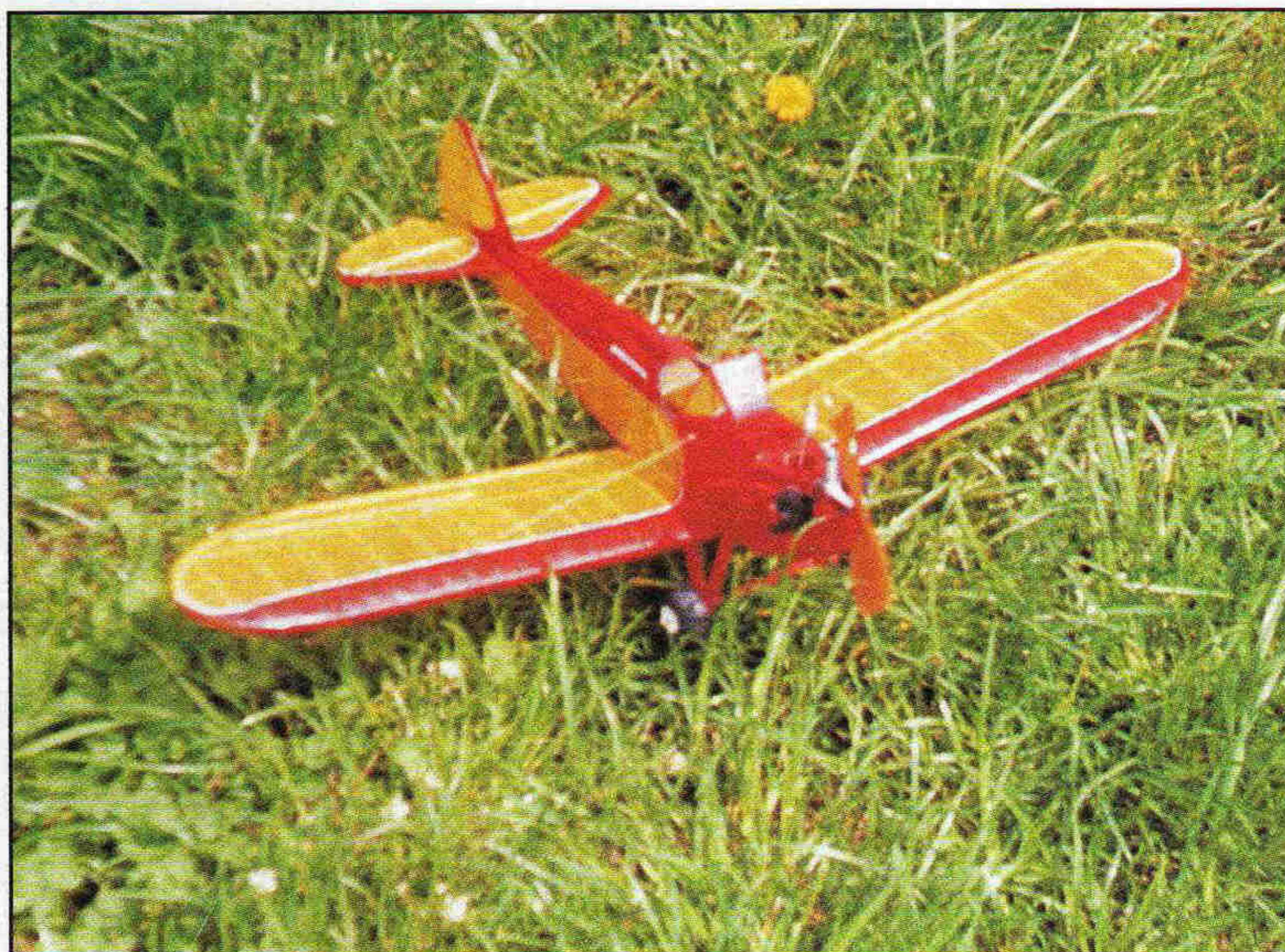
Fly Baby. Model dolnoplošníku od Petra Faitla z Napajedel je v měřítku 1 : 13, k pohonu slouží motor GM-120 na CO 2 .
