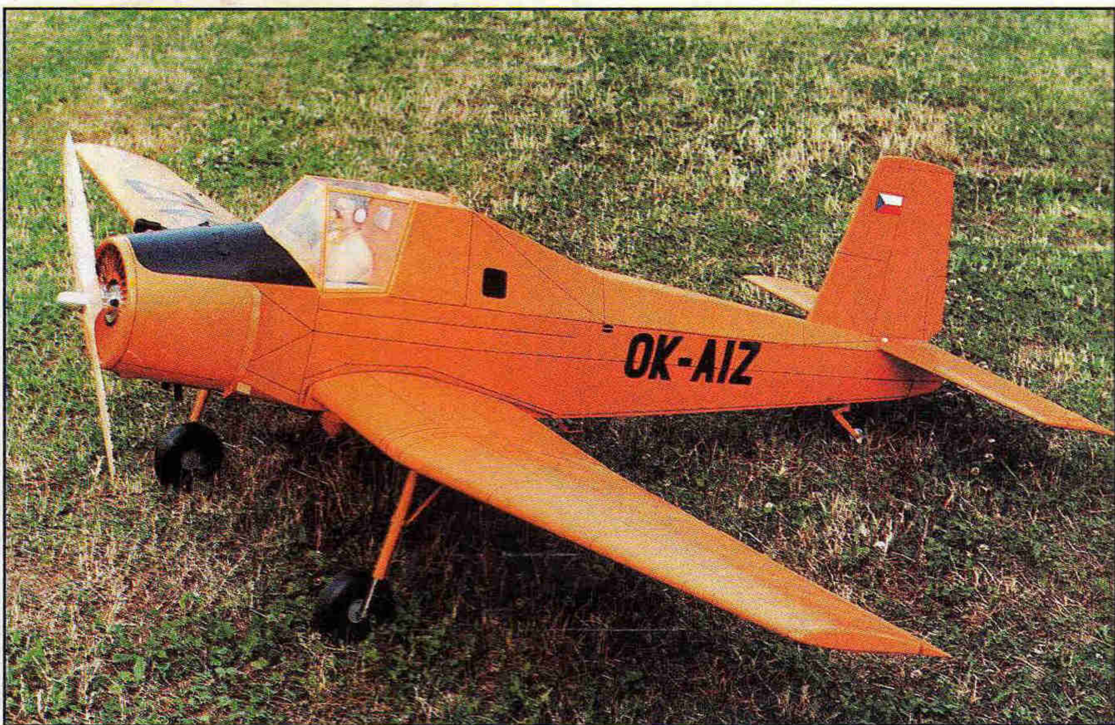
Model Z-37 Čmelák Rudolfa Helmera z Prahy (konstrukce M. Holovlaský) má rozpětí 2750 mm, délku 1800 mm a hmotnost 9,2 kg. Osazen je motorem Titan ZG-62. RC soupravou je ovládána směrovka, výškovka, křídélka, vztlačové klapky, motor a „vypínač“ na vlečení jiného modelu. Pro stavbu byla použita balza, překližka, překližka z bedniček a k potažení materiál Upraca. Povrchová úprava je provedena nitroemallem a akrylátovým lakem.
