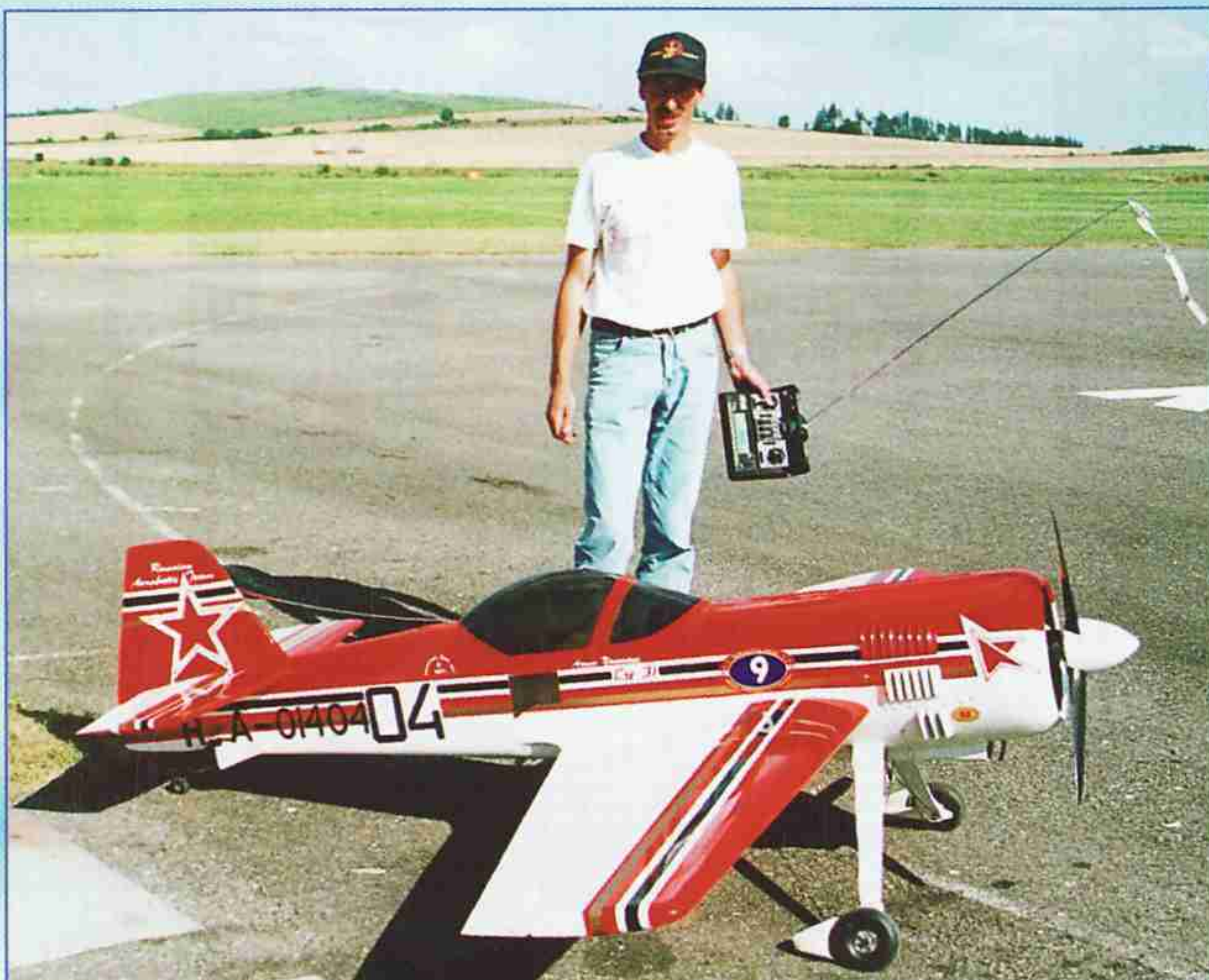
Velmi působivý RC model letadla Su-31 (rozpětí 2600 mm, hmotnost 18 kg, motor King 140 cm 3 ) představil na EAC 1999 v Krnově Němec Armin Naumann.
