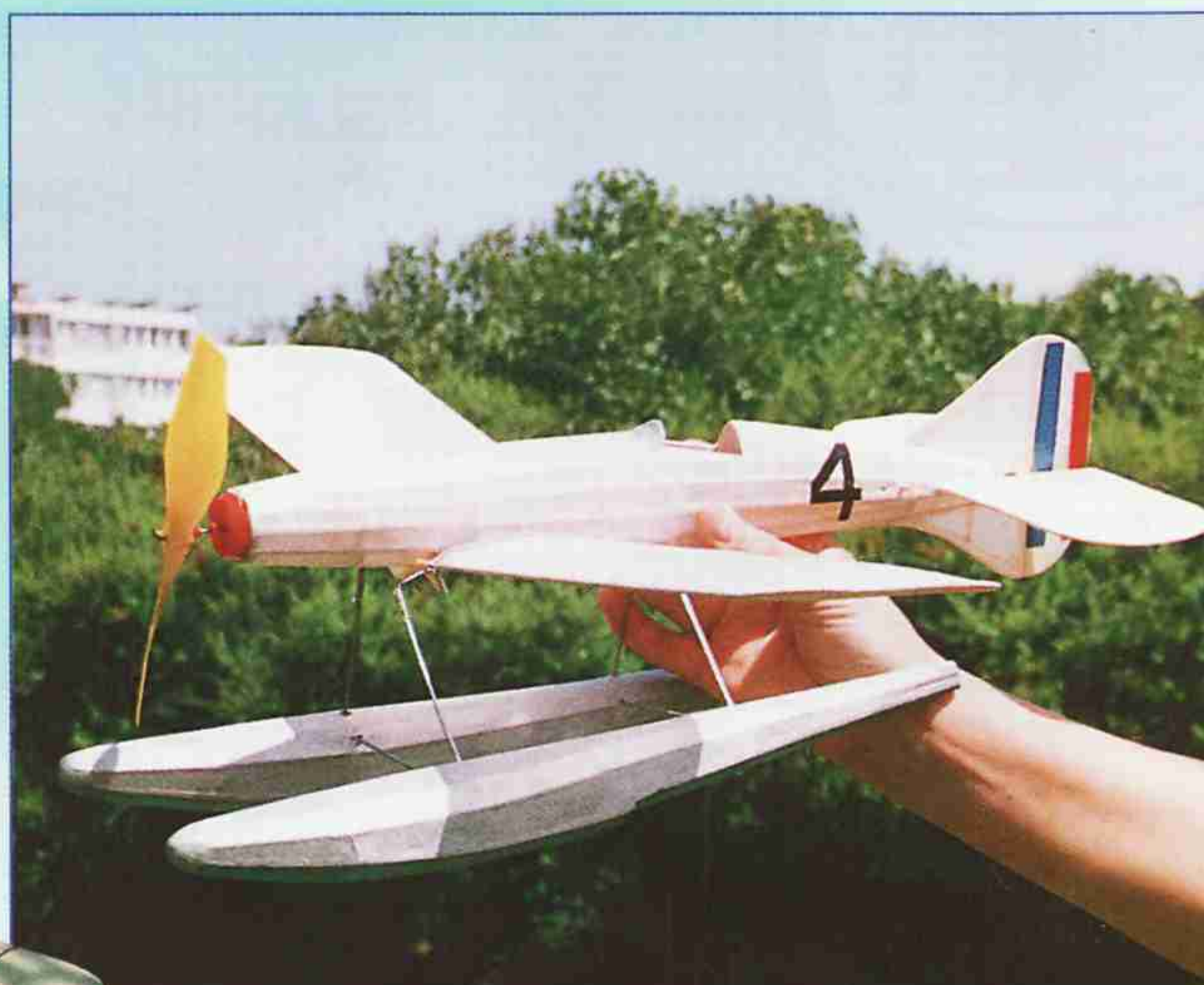
Italský hydroplán Macchi M.67 postavený J. Mařasem z Prahy podle plánu ing. Koutného (Modelář a Modely, č. 6/98). „Peanut“ je poněkud zvětšen, ale i tak velmi dobře létá. Rozpětí 515 mm, délka s plováky 460 mm, hmotnost 40 g, „motor“ 4 vláknů gumy TAN 1x3 mm, vrtule Igra ø 200 mm.
