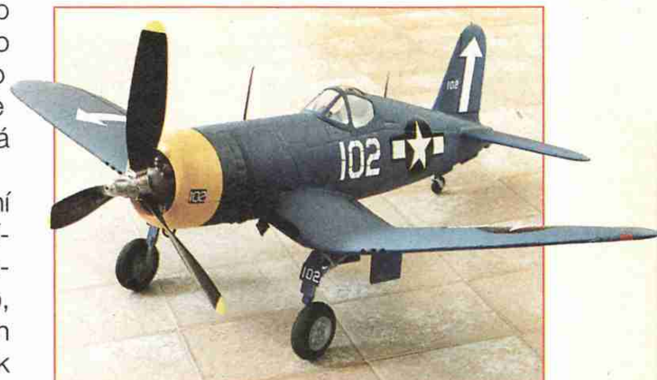
Polystyrenový F4U-1D Corsair (osazený motorem Modela CO2) je rovněž stříkán pistolí, tentokrát barvami Agama.
