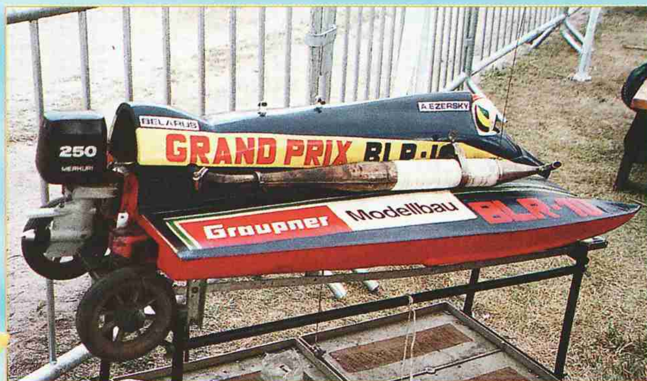
Pohon lodního šroubu u modelu třídy FSR O 15 Alexandra Ezerského z Běloruska je řešen bovdenem (spalovací motor 15 cm 3 ), šroub se natáčí společně s maketou motoru. A. Ezerský s ním po „pomalých“, ale spolehlivých jízdách v této třídě zvítězil. O mistrovství Evropy lodičkářů čtete na straně 26.
