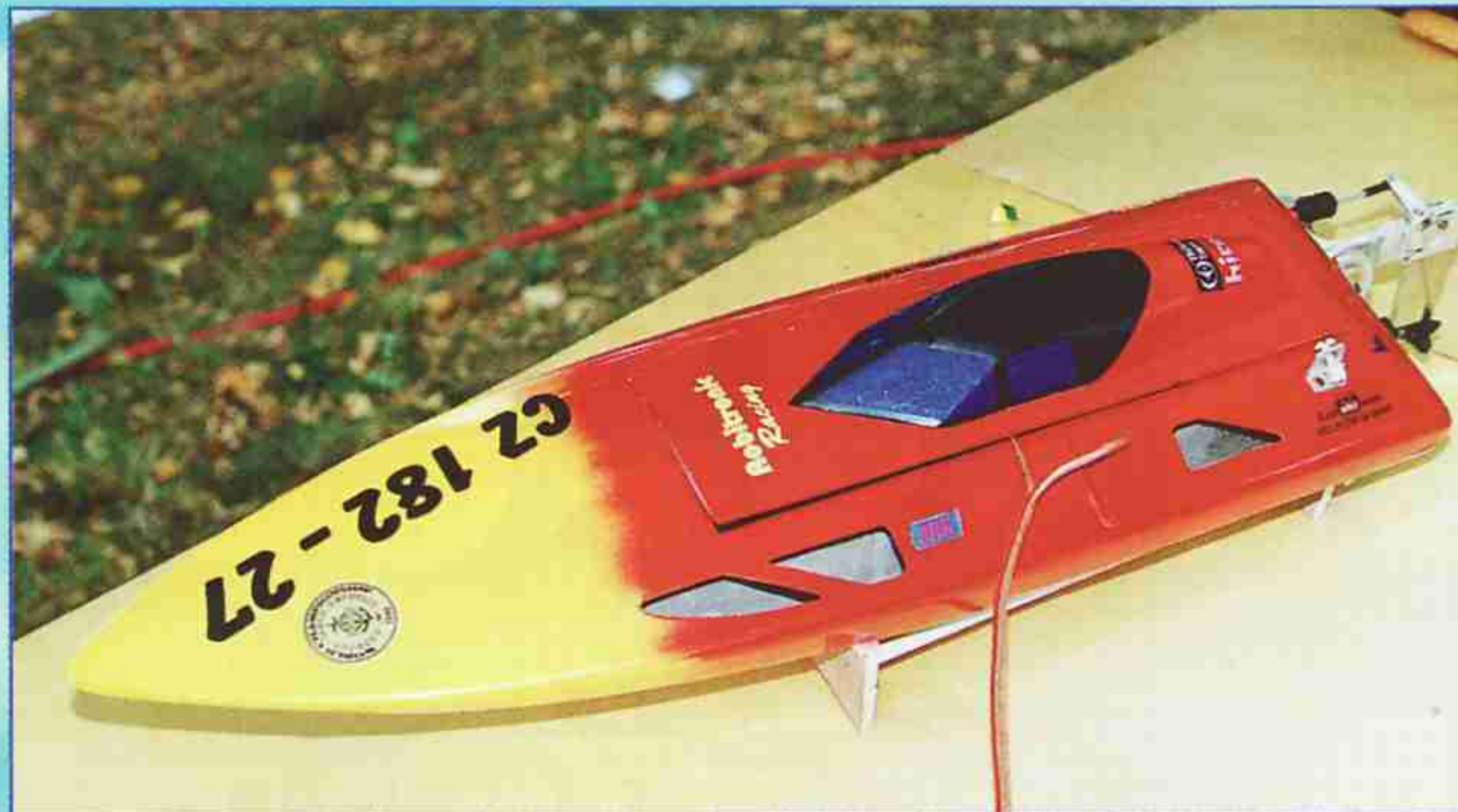
Model člunu Pavla Hynka pro závody třídy FSR-Mono 2. Trup je ze skelného laminátu kombinovaného kevlarem. Délka 580 mm, šířka 160 mm, hmotnost 1600 g, pohon elektromotorem Lehner, resp. lodním šroubem z kompozitu o průměru 36 mm.
