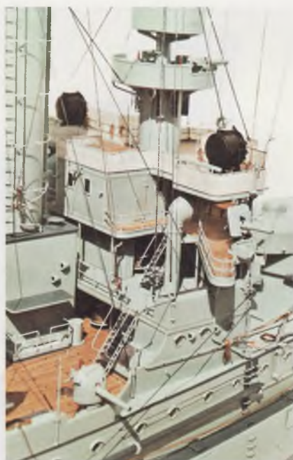
Zadní část přední nástavby. Na velitelském můstku je vidět kabina s mapovnou a 47mm kanon
