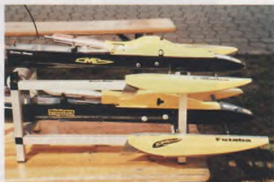
Švédské modely FSR-H 7,5 a 15 vybavené motory CMB. Za povšimnutí stojí jednoduchý stojan na modely z hliníkových profilů, který usnadňuje jejich přenášení
