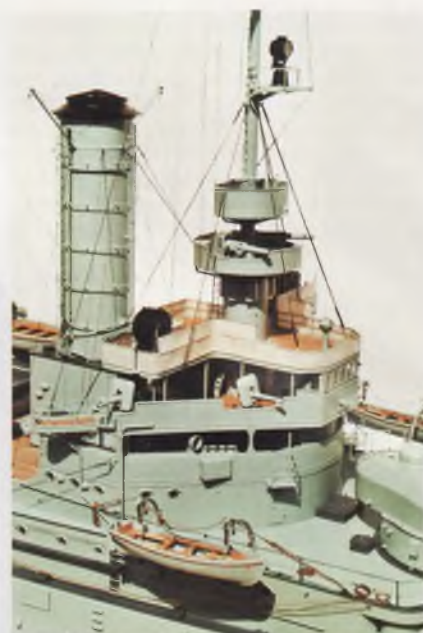
Přední nástavba s velitelským a kompasovým můstkem, bojovým marsem, pozorovatelnou s dálkoměrem a plošinou s reflektorem
