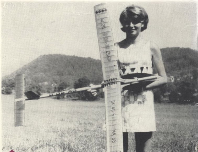
Wakefield M. Nového z LMK Dubí u Teplíc je moderní koncepce s kovovou přední částí trupu, hlavicí a stavitelnou vrtulí
