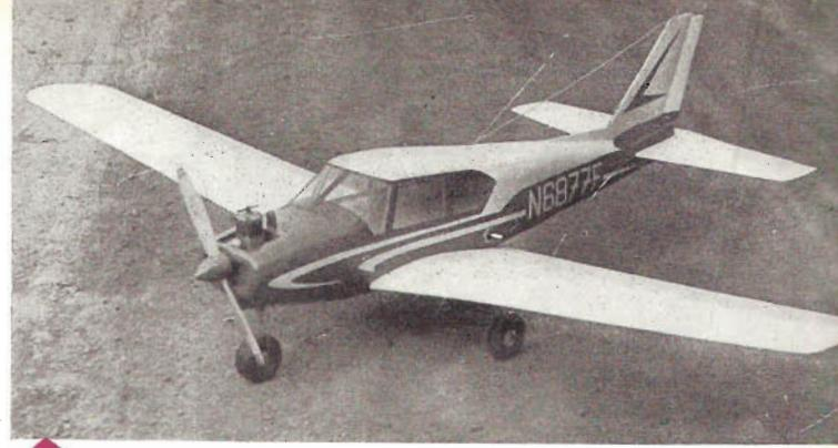
Celobalsová RC maketa Piper Comanche o rozpětí 1100 mm, s motorem FOK 1,5 cm<sup>3</sup> a o váze 1150 g je prací J. Fary z Prahy 8 - Ďáblic
