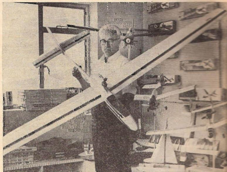
*Konstruktér firmy pan Smith se svahovým RC větronem Big Eagle. V současné době je to největší stavebnicový model firmy, má rozpětí asi 2430 mm, je asi 1630 mm dlouhý a prototyp s osmikanálovým rádiem váží asi 1700 g. Pylon s pomocným motorem je odnímatelný*
