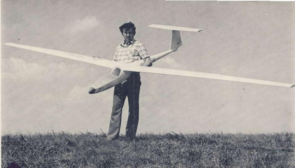
Maketa vétroné VSO-10 o rozpětí 5 metrů a hmotnosti 5 kg je dílem Jindřicha Stejskala z LMK Rokycany. RC souprava ovládá křídélka (každé má zvláštní servo), ocasní plochy, zatahovací podvozek a v budoucnosti i brzdící štítky. Trup je laminátový, křídlo a ocasní plochy balsové
