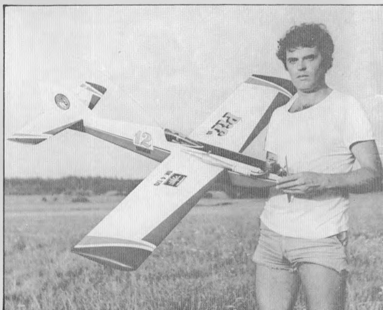
▲ Model pro úvod do kategorie F3A Pif postavil Jaroslav Velc z Kladna. Letoun je navržen pro létání bez podvozku, ten se však – třeba i s plováky – dá namontovat během několika minut. Rozpětí modelu 1350 mm, hmotnost 2300 g; poháněn je motorem MVVS 6,5 RC, souprava Robbe Luna FM ovládá výškovku, směrovku, křídélka a otáčky motoru
