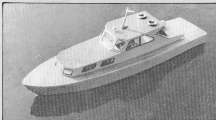
◀ Motorovou jachtu kategorie EX-500 Edita zhotovil podle plánu Modelář č. 57 Josef Hrabáčka ze Spálence. Paluba je ze smrkových lišt, potah trupu z kartónu. Pohonnou jednotku představuje sovětský motor A-287 napájený dvěma plochými bateriemi
